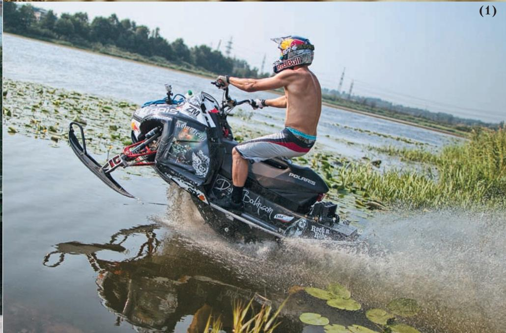
машина опирается только на гусеницу, а полозья глиссируют и практически не касаются воды. Чтобы повернуть, необходимо наклонить идущую на скорости 50–60 км/ч машину в сторону поворота и плавно, не сбрасывая скорость, повернуть. В противном случае, вы рискуете утопить снегоход.
