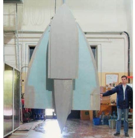
**Аэродинамически – стреловидная «бесхвостка»; гидродинамически – однореданная «летающая лодка»**
