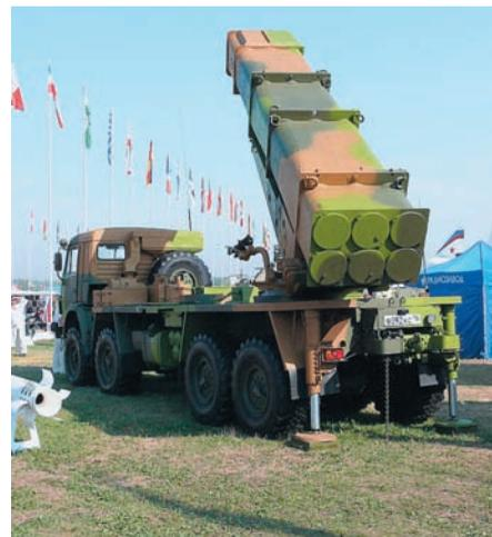
Облегчённая версия РСЗО «Смерч» БМ 9А52-4 на шасси КАМАЗ с шестью реактивными снарядами на выставке «МАКС-2007»
