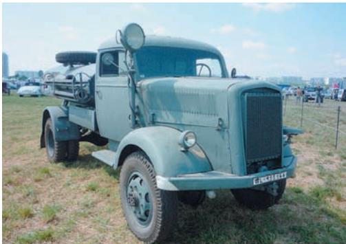
**Опель «Блиц».** Массовая машина 1930–40-х гг., прочная и надёжная. Выпускалась в модификациях с грузоподъёмностью от 1 до 3,5 т, в самых разных вариантах целевого оснащения
