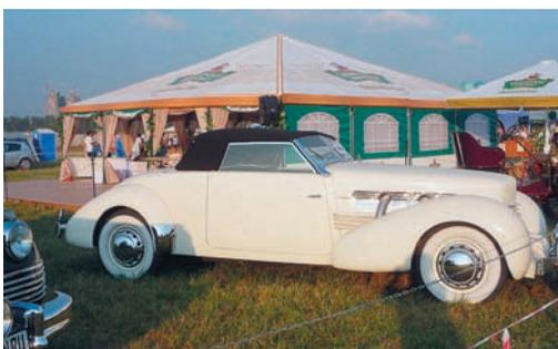
**Корд 812.** Появление его на Нью-Йоркском автосалоне в 1936 г. вызвало сенсацию. Несущий кузов, выдвигающиеся фары, спрятанные внутри дверные петли, передние ведущие колеса, электровальное переключение передач... Впечатляли и характеристики: мощность 8-цилиндрового двигателя 190 л. с., скорость 170 км/ч, разгон до 100 км/ч за 13 с
