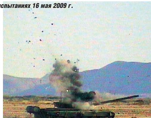
та продемонстрировала возможность автоматического выявления, захвата и поражения цели (танк Т-72) из массива различных транспортных средств. При этом впервые на армейской ракете использовалась система наведения на основе двухрежимного неохлаждаемого ИК-датчика.
