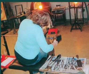
Шлифовка будущей вазы. На столике лежат инструменты, подобными тем, что применялись в стеклорудном деле на протяжении столетий
