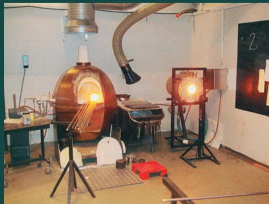
Цех. В печи в расплаве стекла — стеклорудные трубки, основной инструмент мастера
