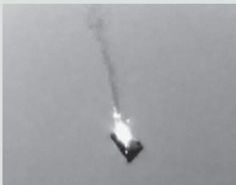
Падение в море сбитого лазером БЛА во время испытаний LaWS в мае 2010 г.
