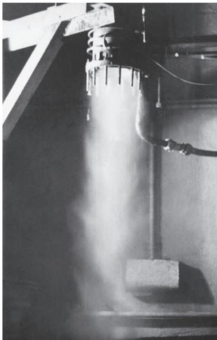
**7. Спиральный поток аэрозоли, рабочее тело — вода+воздух**
