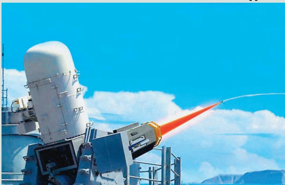
*Рисунок, иллюстрирующий работу корабельной системы лазерного оружия LaWS, смонтированной на платформе артиллерийской установки CIWS Phalanx (в реальности луч лазера невидим)*
