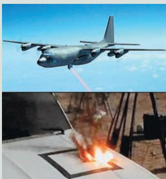
Инфракрасный тактический лазер ATL воздействует на капот автомобиля. В реальности, на верхнем рисунке, луч лазера невидим
