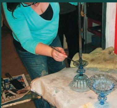
Готовая ваза снимается со стеклорудной трубки
