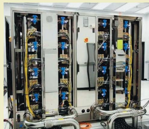
Лазерная установка-демонстратор — laser weapon system demonstrator, разработанная по программе JHPSSL (3-я фаза разработок). На нижнем снимке панели сняты
