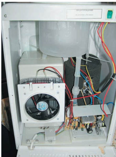
Рис. 3. Кулер со снятой задней крышкой. Видно подключение нагревательных, охлаждающих элементов, резервуары для воды и некоторые датчики температуры
