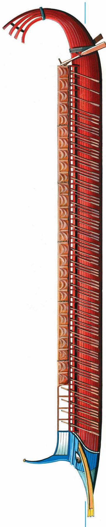
Классическая греческая трирема 500 г. до н.э.: длина — 40 м, ширина корпуса — 4 м, осадка — 1,2 м. Экипаж — до 200 человек, в том числе около 170 гребцов, 10 тяжеловооружённых воинов, шесть лучников, пращников и метателей дротиков, имевших короткие мечи, 14 матросов и задававший гребцам темп флейтист
