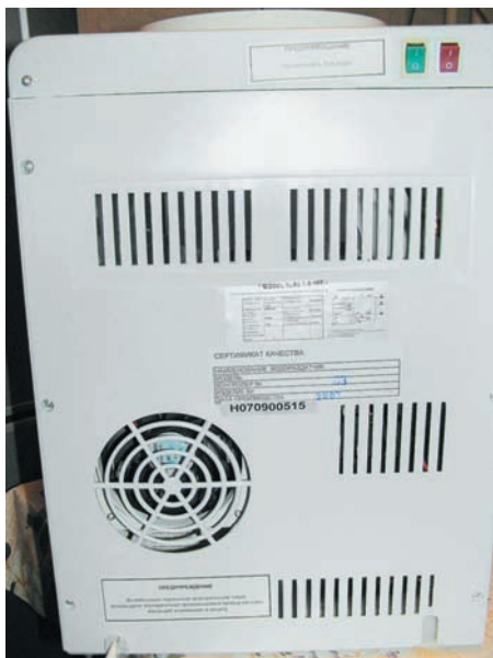
Рис. 2. Вид на заднюю панель кулера Сверху на корпусе кулера установлены переключатели красного и зелёного цвета, обеспечивающие режим автоматического поддержания температуры в резервуарах горячей и охлаждённой воды
