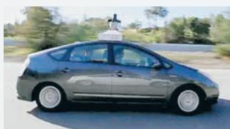
вороте, однако на прямых участках дороги ведёт машину без участия водителя. В настройках электронного «водителя» можно установить различную степень агрессивности езды. Главный сенсор расположен на крыше, другие вмонтированы в лобовое стекло и бамперы.
