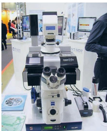
**Рис. 8. Линия Интегра** – это целая «лаборатория на столе». Новый прибор этой линии, представленный на Форуме, предназначен для биомедицинских исследований, с его помощью учёный может «ощупывать» живые клетки и делать вывод об их состоянии
