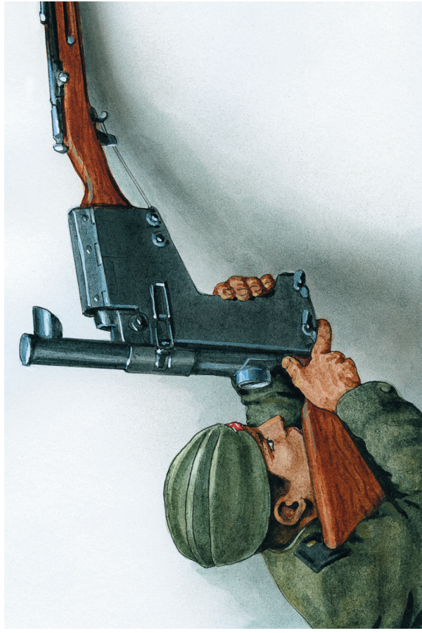
Снайперская «траншейная» винтовка с перископическим прицелом. СССР. 1940-е гг.
