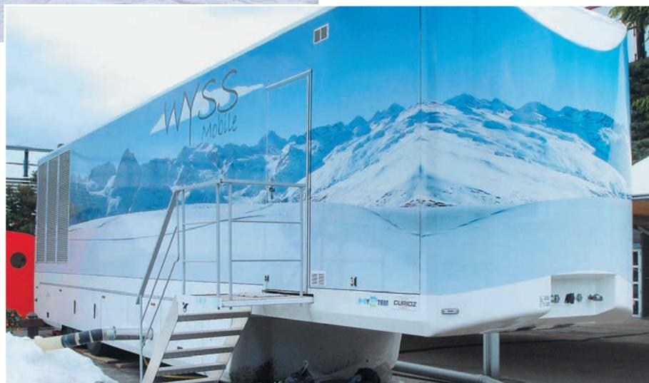
ты, максимально приспособлявая их к конкретным условиям данной трассы в данных погодных условиях. Самая большая модульная установка, которую можно перемещать с места на место, имеет производительность минимум 1200 куб. м в сутки. Она привозится на шести грузовиках, со-
