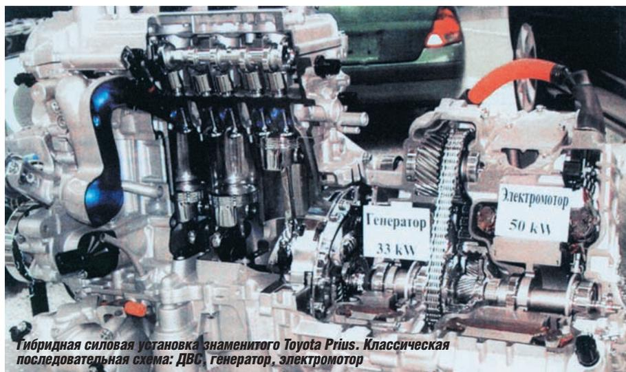
*Гибридная силовая установка знаменитого Toyota Prius. Классическая последовательная схема: ДВС, генератор, электромотор*
