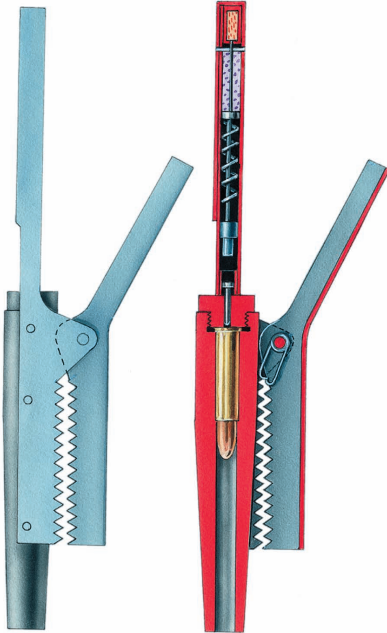
Автоматически действующее стреляющее устройство с «химическим» спуском с заданное интервалом задержки выстрела. Хаммер. США. Середина XX в.
