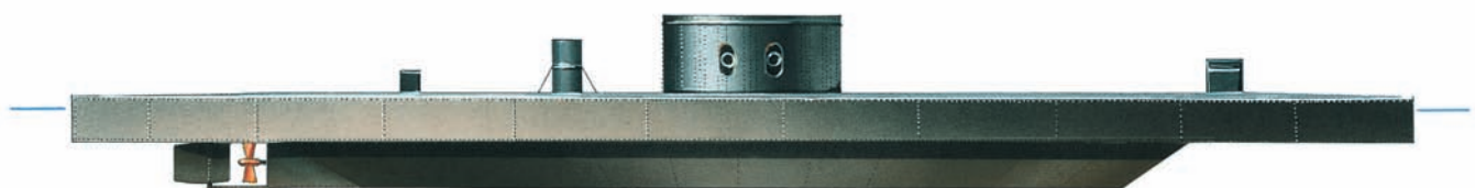
Броненосный корабль северян «Монитор», 1862 г.: водоизмещение — 987 т. Скорость — 7 узлов, вооружение: 2 — 280-мм, мощность силовой установки — 640 л.с., бронирование: пояс — 400 мм, башня — 200 мм, палуба — 25 мм, длина — 52,5 м, ширина — 12,5 м, осадка — 3 м
