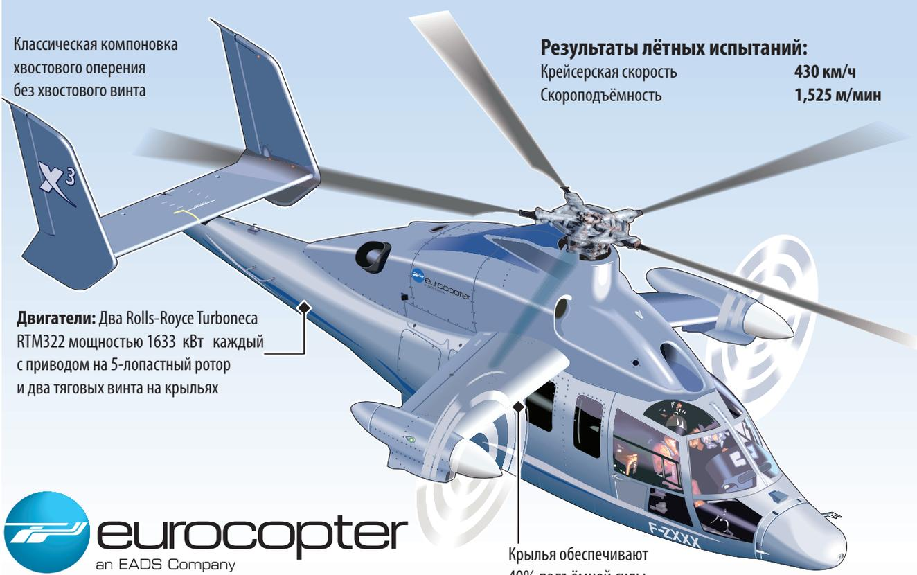
Классическая компоновка хвостового оперения без хвостового винта
