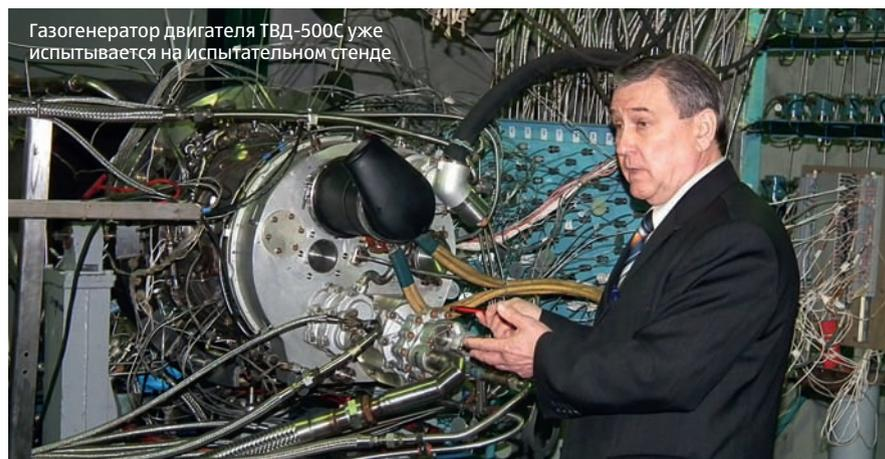
Газогенератор двигателя ТВД-500С уже испытывается на испытательном стенде
