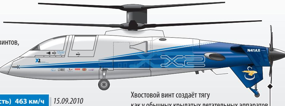
Хвостовой винт создаёт тягу как у обычных крылатых летательных аппаратов
