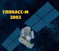
Расчётный срок активного существования 7 лет. Стабильность хронизатора  $1 \times 10^{-13}$ . Разделение сигналов — частотное в четырёх поддиапазонах. Запущено 28 спутников, потеряно три, планируется запустить ещё несколько до ввода в строй аппаратов 3-го поколения
