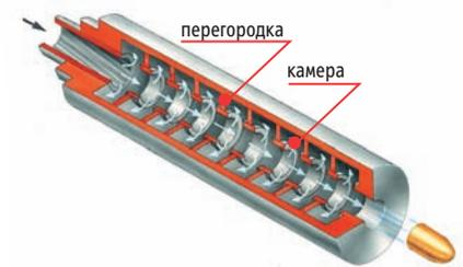
Классический многокамерный глушитель расширительного типа
