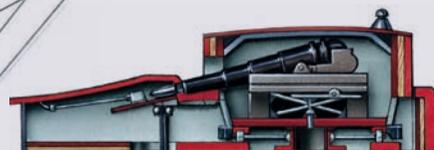
Дульно-зарядная башенная установка английского броненосца «Инфлексибл». 1881 г.
