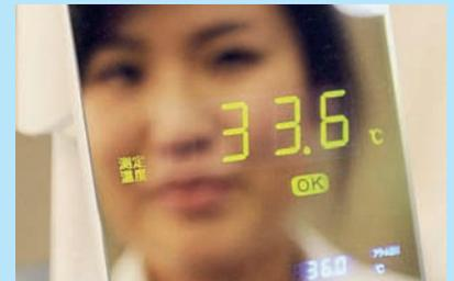
Японский электротехнический концерн NEC Avio Infrared Technologies разработал гаджет Thermo Mirror — первое в своём роде устройство, которое измеряет температуру человека, находящегося поблизости. Достаточно просто посмотреть в зеркало, не прикасаясь к нему, и через несколько секунд на его поверхности высветится результат. Если температура окажется слишком высокой, то градусник-зеркало подаст тревожный звуковой сигнал.
