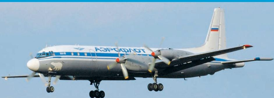
На этой фотографии – редчайшая машина Ил-18РТ, самолёт – измерительный пункт. Её назначение – телеметрическое обеспечение испытаний ракетной и космической техники, в том числе баллистических ракет, стартующих с подводных лодок. Все Ил-18РТ входят в состав авиации ВМФ, эта машина относится к Северному флоту, отсюда и белый медведь
