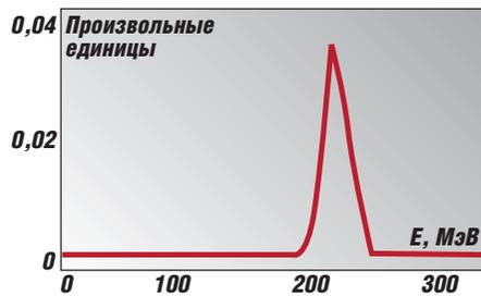
**Спектр протонов из плазмы, содержащей ионы алюминия и протоны. Хорошо виден пик, характеризующий малый разброс энергий частиц пучка**
