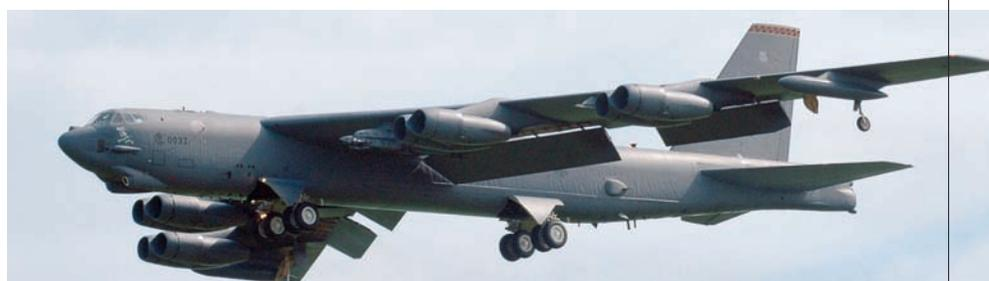
Впрочем, как и его американский «товарищ» В-52. На врезке – передние стойки велосипедного шасси этого самолёта. Оно сыграло с машиной злую шутку: когда на вооружение были приняты ядерные крылатые ракеты AGM-86, оказалось, что на внутренней подвеске можно разместить только одну револьверную пусковую установку на восемь ракет. Сама по себе общая длина бомбоотсеков позволяла разместить две ПУ, но помешали эти передние стойки, расположенные, как оказалось, в неудачном месте...
