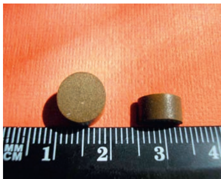
Такой окончательный вид принимают керамические «таблетки» фосфата цезия. Металлическая оболочка здесь тоже будет сооружена, но её разрушение не станет катастрофическим, как в случае с хлоридом цезия
