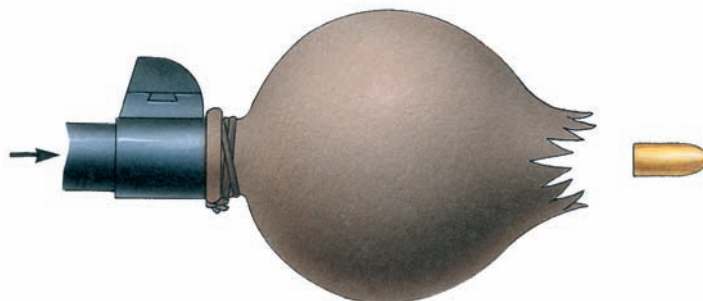
Простейший механический глушитель расширительного типа переменного объема — обычная детская соска, надетая на срез ствола
