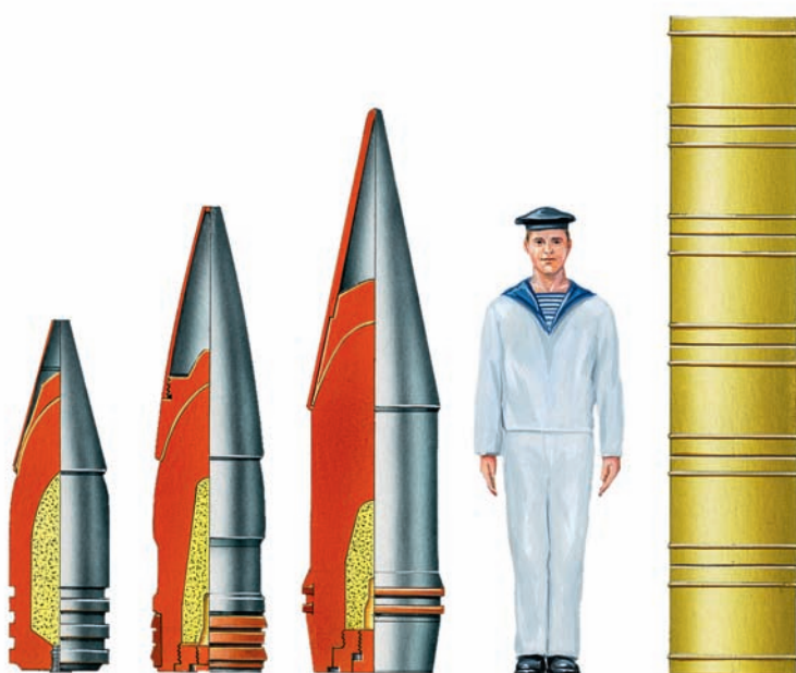
Бронебойные снаряды корабельных орудий главного калибра в сравнении с человеком среднего роста (слева направо): 340-мм французский образца 1912/21 г. (линкор «Бретань»); 380-мм немецкий (линкор «Бисмарк»); 460-мм японский (линкор «Ямато») и его пороховой заряд
