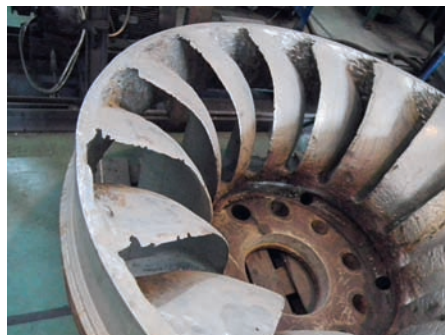
Рабочее колесо гидротурбины после эксплуатации. После наплавки «заплаток» и последующего газоплазменного напыления защитного покрытия сердце гидроагрегата станет долговечнее, чем «новорожденное».
