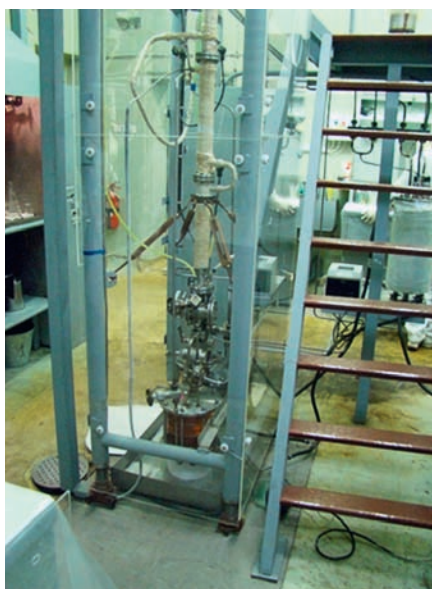
Линейный кристаллизатор непрерывного действия, реализованный на базе ЦЗЛ ОАО «СХК»
