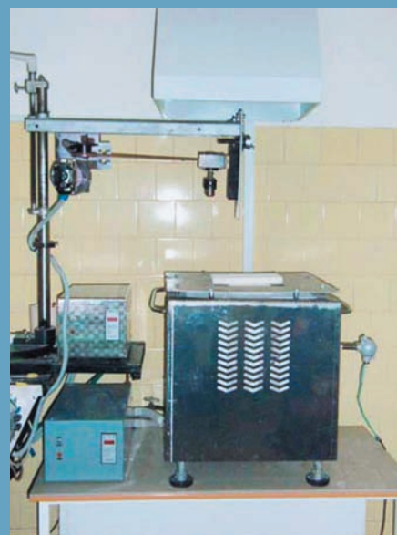
Печь для варки стёкол при температурах до 1650°C, укомплектованная стекломешальной машиной
