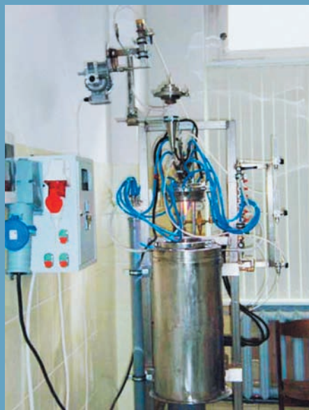
Общий вид плазматрона, с помощью которого при температуре выше 8000°C происходит сферондизация частиц
