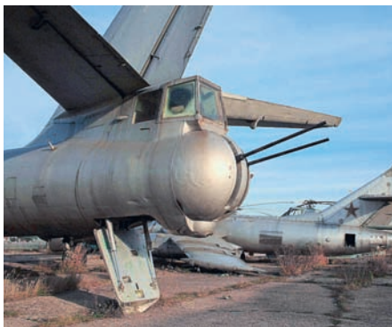
23-миллиметровые пушки хвостовой турели фронтального бомбардировщика Ил-28 ещё пытаются смотреть в небо... На заднем плане – Як-25, первый в нашей стране всепогодный перехватчик
