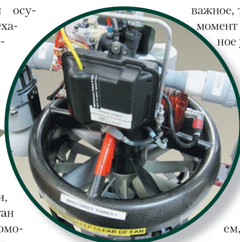
Вид на БЛА сверху. Видна крыльчатка вентилятора и кольцевой обтекатель
