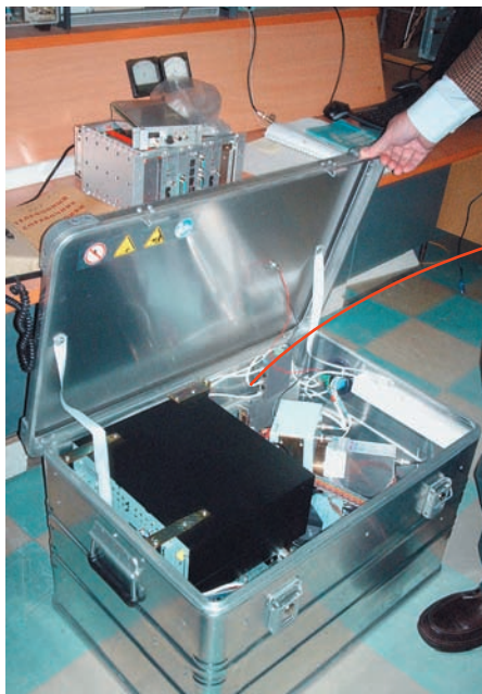
При эксплуатации эта крышка закрыта. Для управления и чтения результатов к прибору подключается ноутбук
