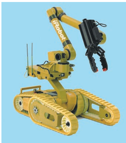
Робот Warrior 710 с мощным захватом
