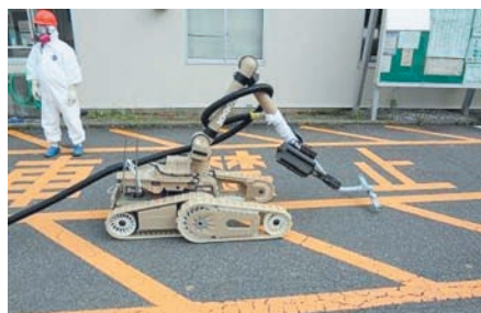
Робот Warrior с насадкой и шлангом для очистки помещений реактора
