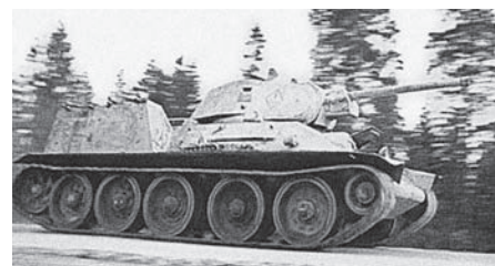
Т-34, оснащённый батареей ФОГ-2. Огнемётот установлены на надгусеничных полках
