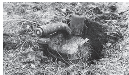
Установка ФОГ-2 на позицию (маскировка снята)
