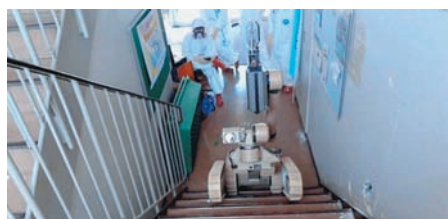
Японские операторы тренируются управлять роботом Warrior на лестнице. Справа от робота видна пробоина в гипсокартонной стене, сделанная во время тренировок
