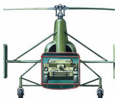
Горизонтальный стабилизатор с концевыми шайбами
