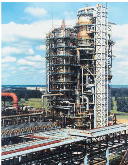
Современная установка каталитического крекинга «вакуумных дистиллятов» мощностью 1 млн т в год по сырью, работающая на Омском НПЗ
