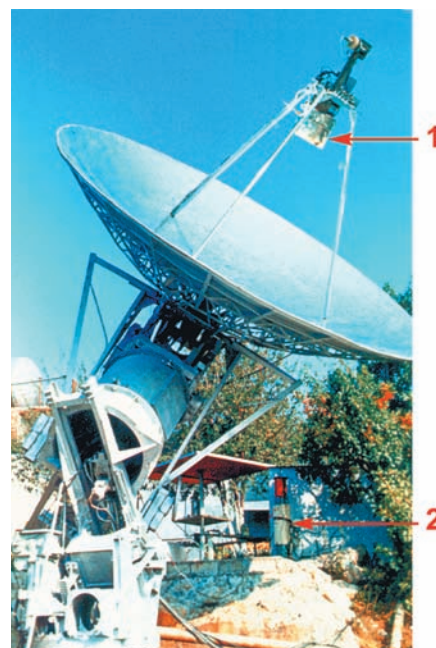
Опытная установка с полезной мощностью 2,4 кВт и КПД 43% для термокаталитического преобразования солнечной энергии в энергию химического топлива путём проведения эндотермической конверсии метана с водяным паром в смесь водорода и угарного газа в солнечном каталитическом реакторе СКР-3 (1) (испытания проведены в Крыму в 1984–1985 гг.). Диаметр параболического зеркального концентратора солнечного света — 5 м. Вертикальный цилиндр (2) — каталитический реактор для выделения запасённой энергии в виде теплоты с температурой около 600°C и регенерации исходной реакционной смеси «метан + вода». Общий КПД цикла около 20%
