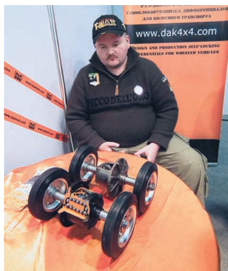
ДАК — дифференциал автоматический Красикова — и его классический собрат
