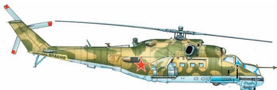
Вертолёт Ми-24П. Пушечный вариант с двухствольной пушкой калибра 30 мм
