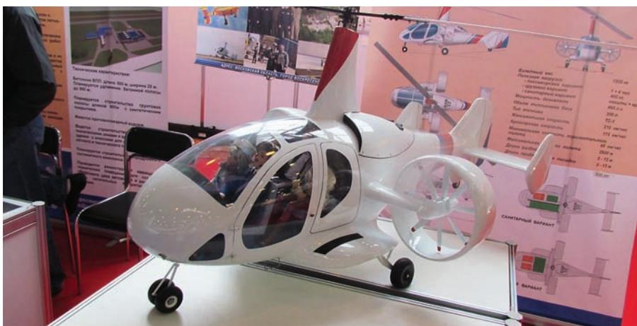
**Модель автожира «ГиРос-3», вентиляторы на котором расположены по бокам фюзеляжа и приводятся в движение через трансмиссию от двух роторных двигателей**
