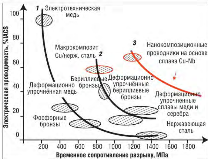
Рис. 1. Характеристики различных типов материалов для электропроводов
