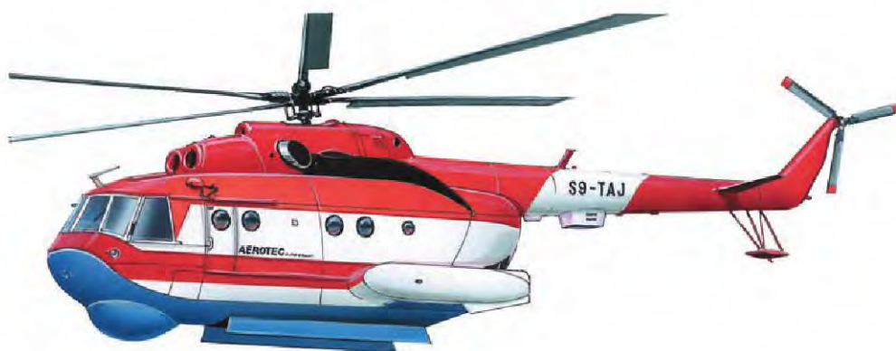
Вертолёт-пожарный Ми-8ПЖ. Люк для слива воды открыт. 1994 г.
