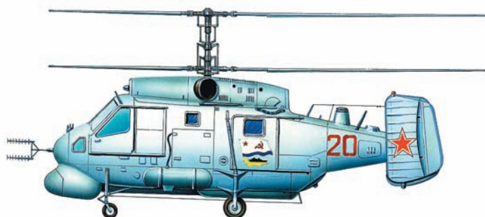
Вертолёт противолодочной обороны Ка-25ПЛО. Он отличался отсеком для торпед под фюзеляжем за обтекателем РЛС и магнетометром на верхней поверхности хвостовой балки
