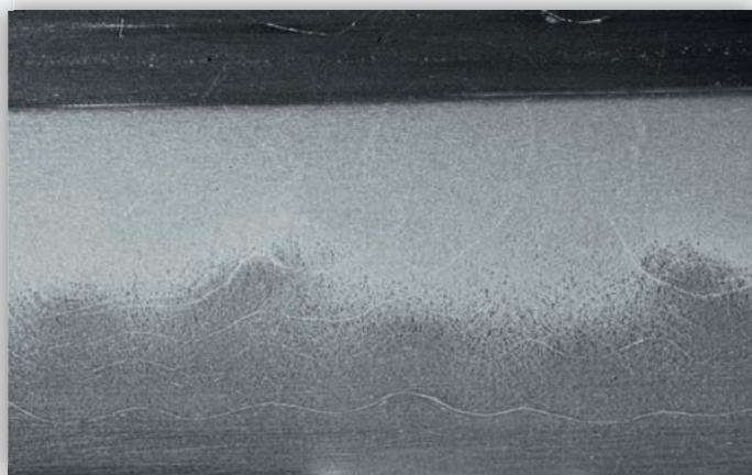
Тот же клинок, фрагмент около 50 мм. Клинок выкован из сварной стали, в структуре которой — не менее 500 000 волокон!
