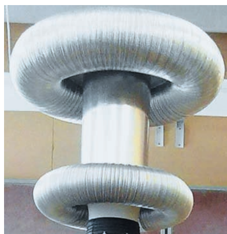
Тороиды для увеличения ёмкости вторичного контура накопления энергии перед образованием стримера (разряда)
