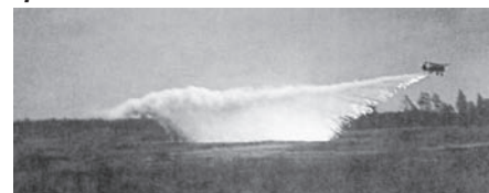
Огненный дождь. Сброс огнесмеси с самолёта с помощью зажигательного прибора ВАП-4. СССР. 1930-е гг.
