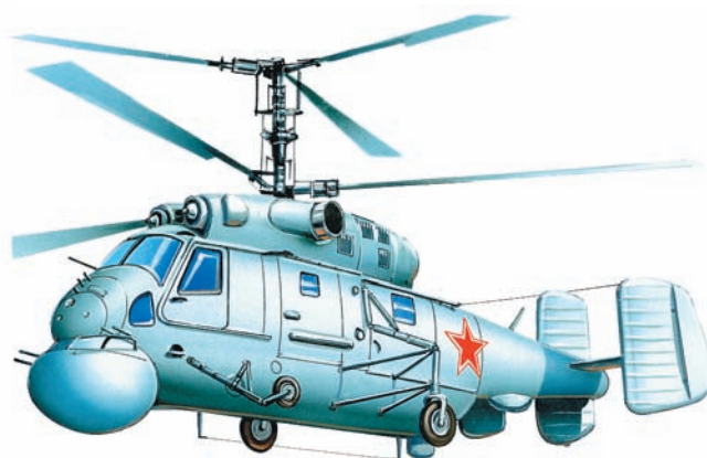
Вертолёт Ка-25Ц. Особенность вертолёт-целуказателя — увеличенный обтекатель антенны РЛС. Для улучшения её работы в полёте стойки шасси поджимались к фюзеляжу
