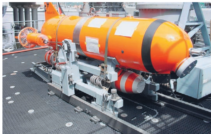
Подводный аппарат «Пингвин» В-3: вес — 1320 кг, скорость — 6-8 узлов, длина кабель-троса — 1000 м, диаметр — 8 мм, рабочая глубина — 100 м, автономность — 2-3 ч, длина — 3,5 м, ширина — 1,5 м, высота — 1,4 м
