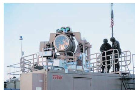
Опытный образец американского твёрдотельного боевого лазера. Предполагается устанавливать такое оружие на тактических истребителях F-35
