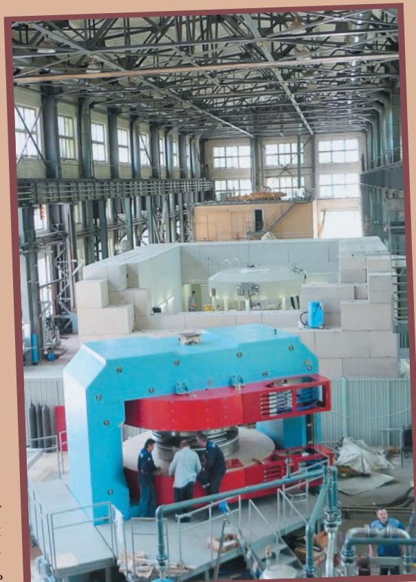
Инженерный центр по сборке медицинских ускорителей. На переднем плане – ускоритель для технологической линии производства трековых мембран (см. «Техника – молодёжи» № 7 за 2009 г.). За ним, в ограждении из бетонных блоков, – протонный ускоритель для Димитровградского медицинского центра
