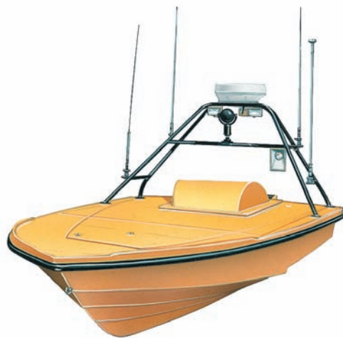
Патрульный катер «Гауст гард»: длина — 5,7 м, мощность силовой установки — 266 л.с.
