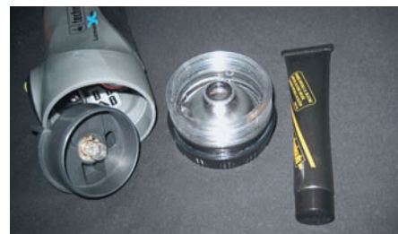
6. Разобранный фонарь LUMEN. Рядом тюбик специального силикона, которым нужно время от времени обрабатывать самую важную часть любого подводного фонаря — резиновое кольцо — прокладку, не допускающую воду внутрь корпуса
