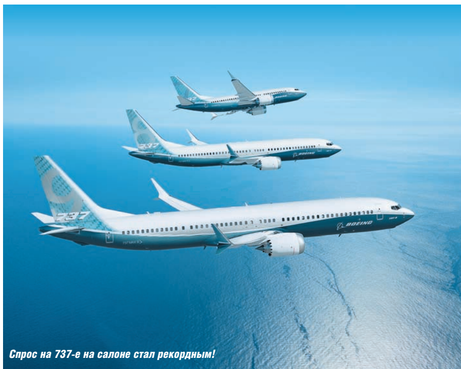
Законцовка крыла авиалайнера выполнена в виде акулье плавника — шарклета, что улучшает аэродинамические качества
