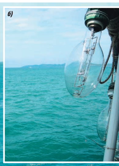
4. Небольшая флотилия судов ждёт захода солнца для ночного лова в Сиамском заливе. Кораблики местных рыбаков (a) оснащены огромными «световыми мачтами», на которых размещены мощные лампы (б), питаемые генераторами двигательных установок
