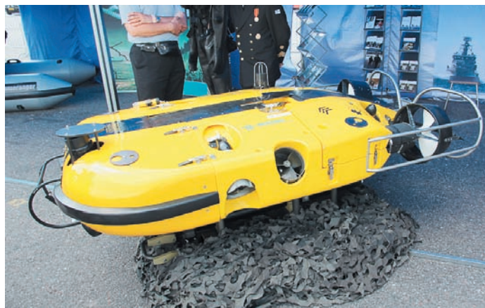
Подводный аппарат «Дабл игл»: длина — 1,7 м, ширина — 1,3 м, высота — 1,5 м, рабочая глубина — 300 м, скорость — 5 узлов, радиус действия — 600 м, вес заряда — 30 кг, вес аппарата — 200 кг
