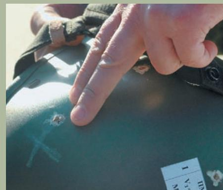
*Следы от попадания пуль из СВД с наружной стороны защитного элемента бронежилета*
