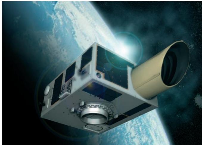
**Канадский аппарат NEOSat (Near-Earth Object Surveillance Satellite, спутник наблюдения за околоземными объектами). Он запущен в конце февраля текущего года, это первый канадский космический телескоп и, главное, первый спутник, предназначенный специально для поиска опасных астероидов, а также отслеживания космического мусора. Аппарат небольшой – 65 кг – и недорогой – \$25 млн. Летает по орбите высотой 800 км с периодом обращения 100 мин**
