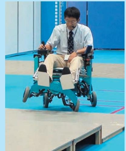
Исследователи из Технологического института Чибы (Япония) разработали роботизированное инвалидное кресло, способное преодолевать препятствия и взбираться по лестницам. Кресло оснащено специальными электроприводами, благодаря которым может приподнимать колёса и подниматься по ступенькам. Разумеется, это возможно только в том случае, если ступеньки имеют достаточные размеры, чтобы каталка на них поместилась.
