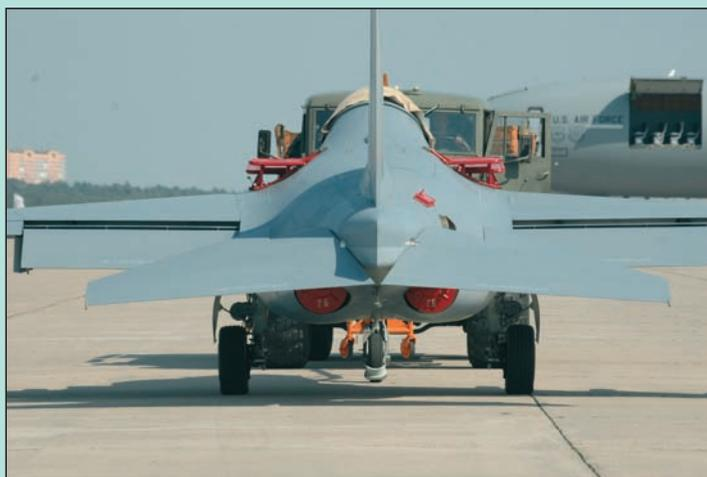
**Закрылки нового УТС выполнены из композитных материалов – так же, как хвостовое оперение; доля таких материалов в массе конструкции – 25%**
