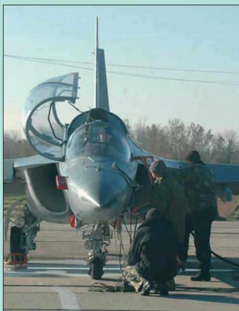
Встроенный контроль, конечно, работает и сейчас, но всё же предназначен он в первую очередь для полёта. А в ходе предполётной подготовки проводятся более глубокие проверки, для чего требуется подключение наземного оборудования
