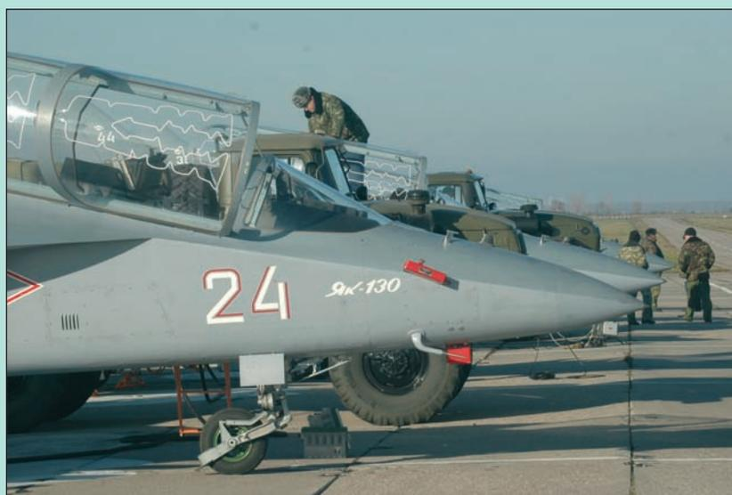
Одно из основных требований к учебной машине – максимальная безопасность для экипажа. Этот узор из ломаных линий – тоже безопасность. Это шнур из взрывчатого вещества. При катапультировании он взрывается и «вырезает» кусок остекления – и не нужен механизм сброса фонаря, который ведь может быть повреждён...
