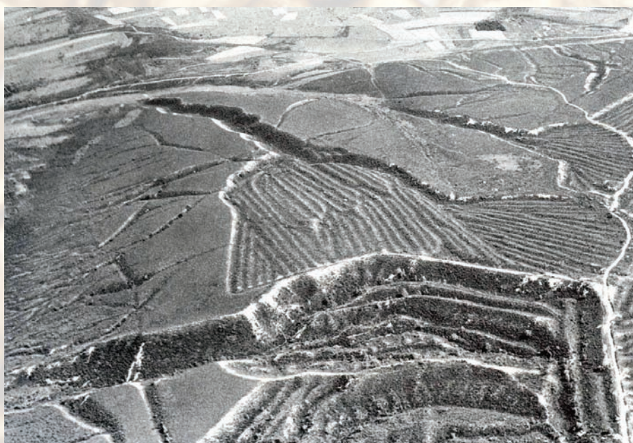
Рис. 11. Вид резервуаров-накопителей на вершине горного массива и нижележащая система искусственных рвов для движения водных потоков и обломочного материала
