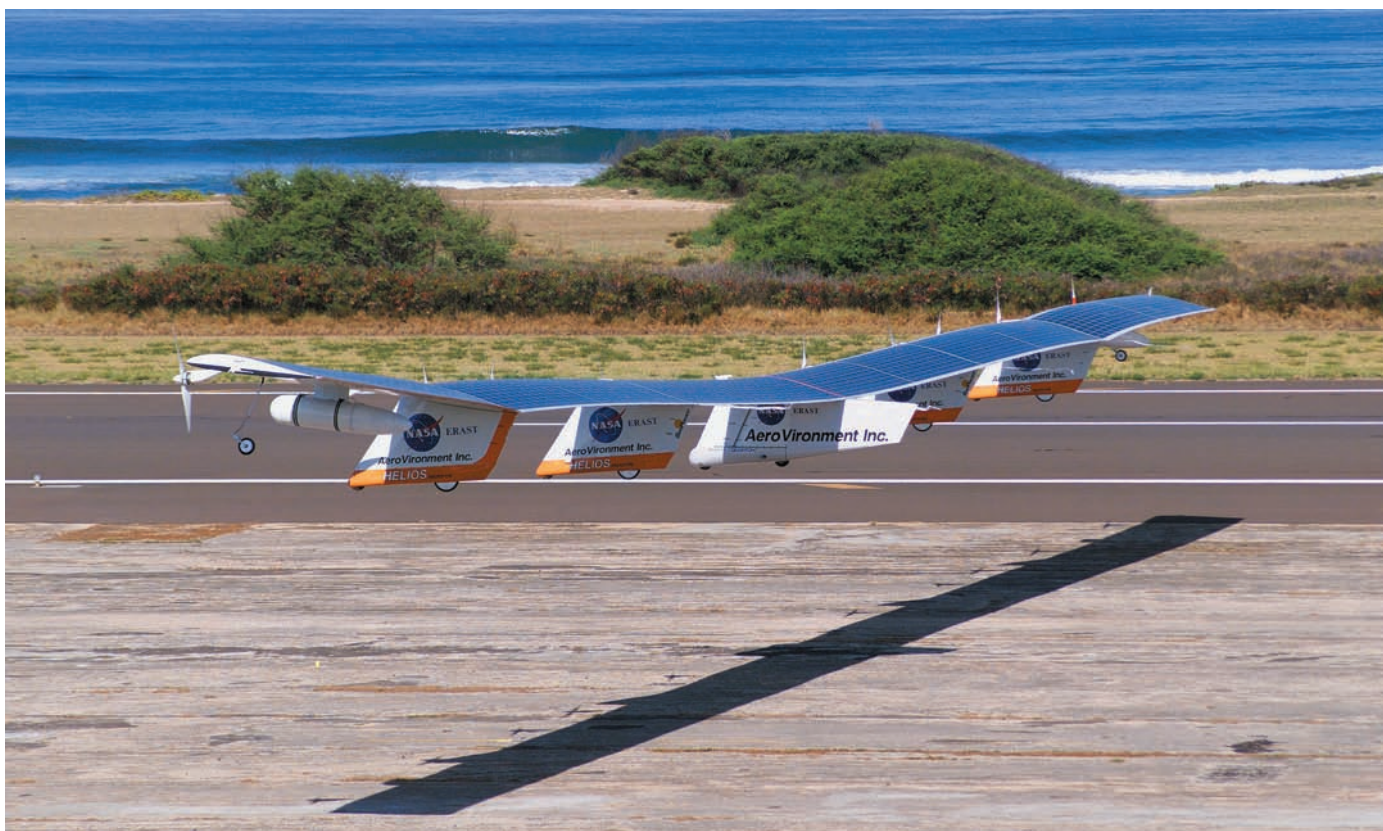
Один из громадных «солнечных» беспилотников программы ERPA — Helios Prototype. Размах крыла 75,3 м — больше, чем у самых больших самолётов. Но при этом вес — всего 272,4 кг...
