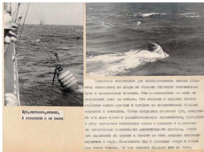
Постановка в океане многотонного буя с самописцами течений — нелёгкая задача. «Буй поставив, отошли, а вернулись — не нашли» — шутили моряки «Седова»
