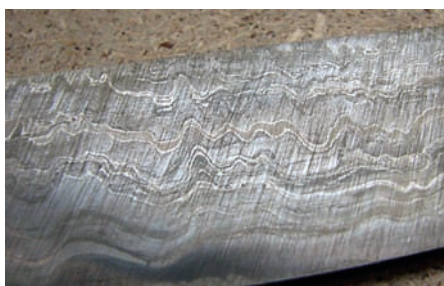
Структура трёхслойной заготовки после травления
