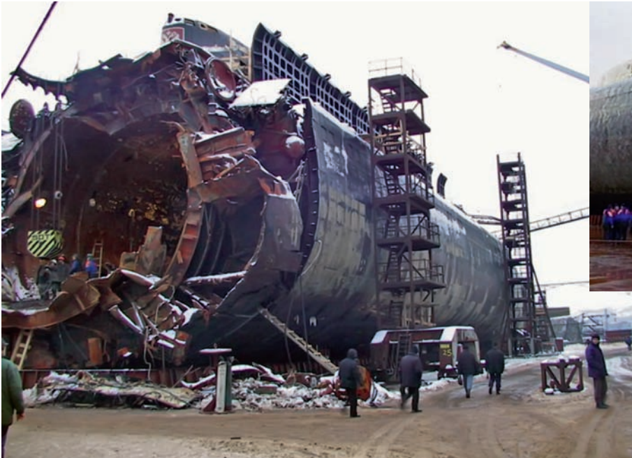
АПЛ «Курск» после подъёма. На правом борту хорошо видна круглая пробоина между вторым и третьим отсеками в лёгком корпусе лодки
