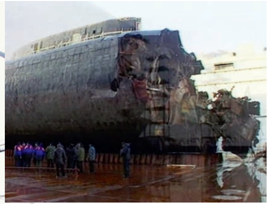
АПЛ «Курск» после подъёма. На правом борту хорошо видна круглая пробоина между вторым и третьим отсеками в лёгком корпусе лодки
