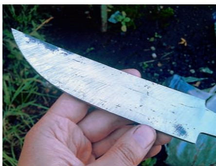
Откованная трёхслойная заготовка для ножа после черновой слесарной обработки
