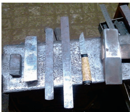
Последовательность работы: слиток булата, брусок метеорита, полоса булата, полоса метеорита, нож из метеоритного железа дан для масштаба. Все это лежит на наковальне, рядом молоток
