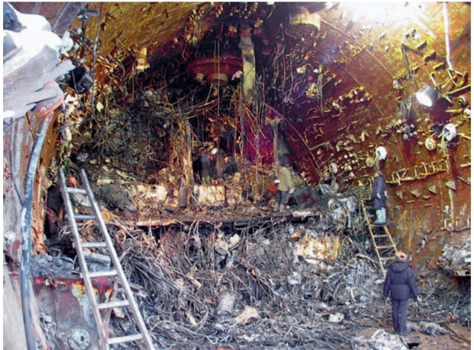
Внутренности АПЛ «Курск». Хорошо видны результаты воздействия ударной волны от взрыва, но совершенно не видно следов пожара
