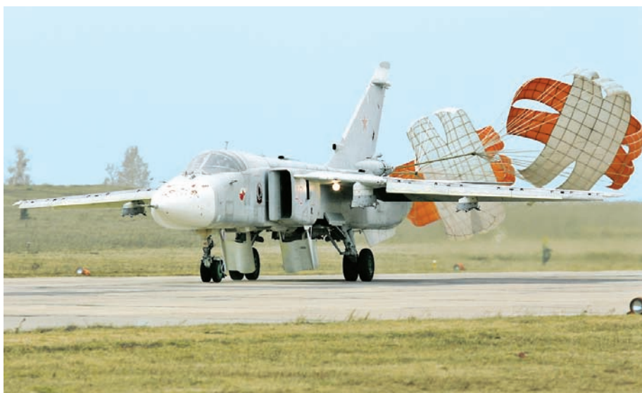
Крестообразные тормозные парашюты конструкции Глушкова на советских самолётах МиГ-21, Су-24 и МиГ-31
