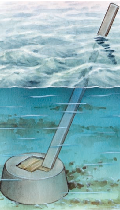
Противодесантная мина типа I (Nussknackermine I). Бетонное основание в форме усечённого конуса. Наклонно вверх на высоту 3 м выступает металлическая балка или рельс, играющая здесь роль наклонного датчика цели. Внутри основания помещаются две противотанковые мины Т.Мі.42 или Т.Мі.43 Pilsz
