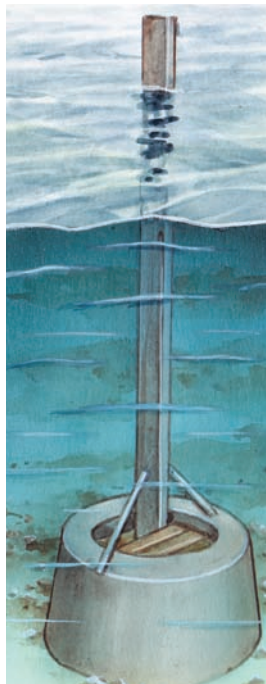
Противодесантная мина типа II (Nussknackermine II). Бетонное основание в виде усечённого конуса. Однако датчик цели (стальная балка или рельс) устанавливался вертикально и удерживался в этом положении с помощью упоров и растяжек. Две противотанковые мины Т.Мі.42 или Т.Мі.43 Pilsz располагались по обе стороны нижнего конца этой штанги внутри основания
