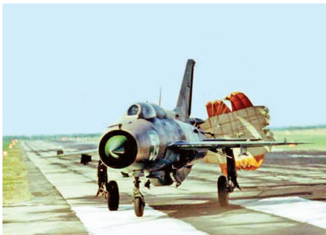
Крестообразные тормозные парашюты конструкции Глушкова на советских самолётах МиГ-21, Су-24 и МиГ-31
