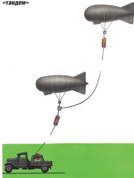
Схема подъёма АЗ системы «тандем»
