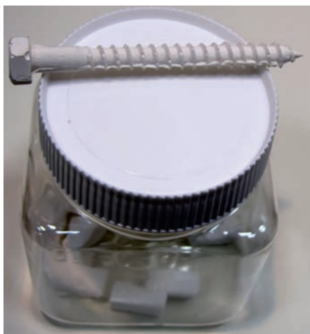
Шуруп из керамики держит сломанные кости до тех пор, пока они не срастутся. А сам тем временем постепенно растворяется, заменяясь естественной костной тканью
