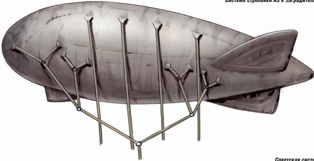
Советская система АЗ: кроме раскрывшегося парашюта, к вражескому самолёту по тросу съезжает мина. СССР, Великая Отечественная война
