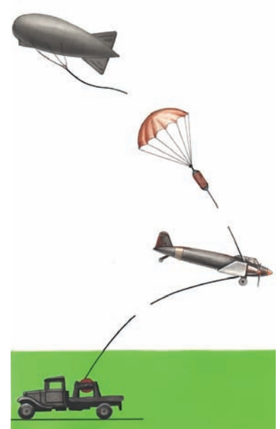
Советская система АЗ: кроме раскрывшегося парашюта, к вражескому самолёту по тросу съезжает мина. СССР, Великая Отечественная война
