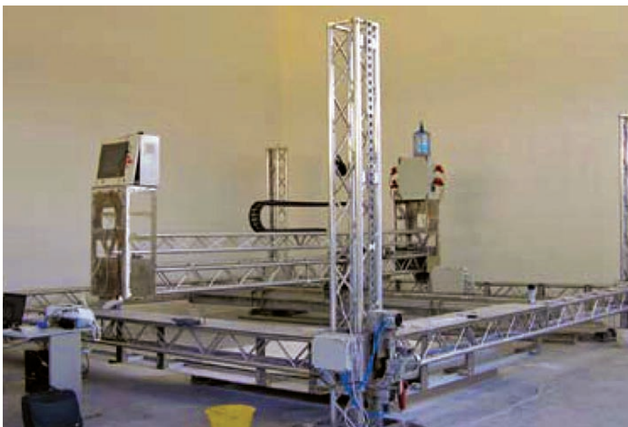
«Строительная» АТ-установка фирмы d-Sape...
