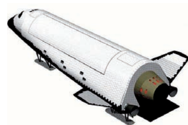
МТК-ВП в конфигурации перед посадкой: стабилизаторы в рабочем положении (на старте они сложены), посадочные лыжи выпущены
