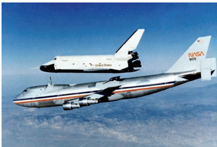
Слева: специально построенная для испытаний орбитальная ступень «Энтерпрайз» отделяется от самолёта-носителя Боинг 747. У нас это называлось — горизонтальные лётные испытания (ГЛИ). Подходящего носителя тогда не было — «Мрия» ещё не была готова, — поэтому на корабль пришлось ставить воздушно-реактивные двигатели (см. ТМ №11 за 2013 г.).
