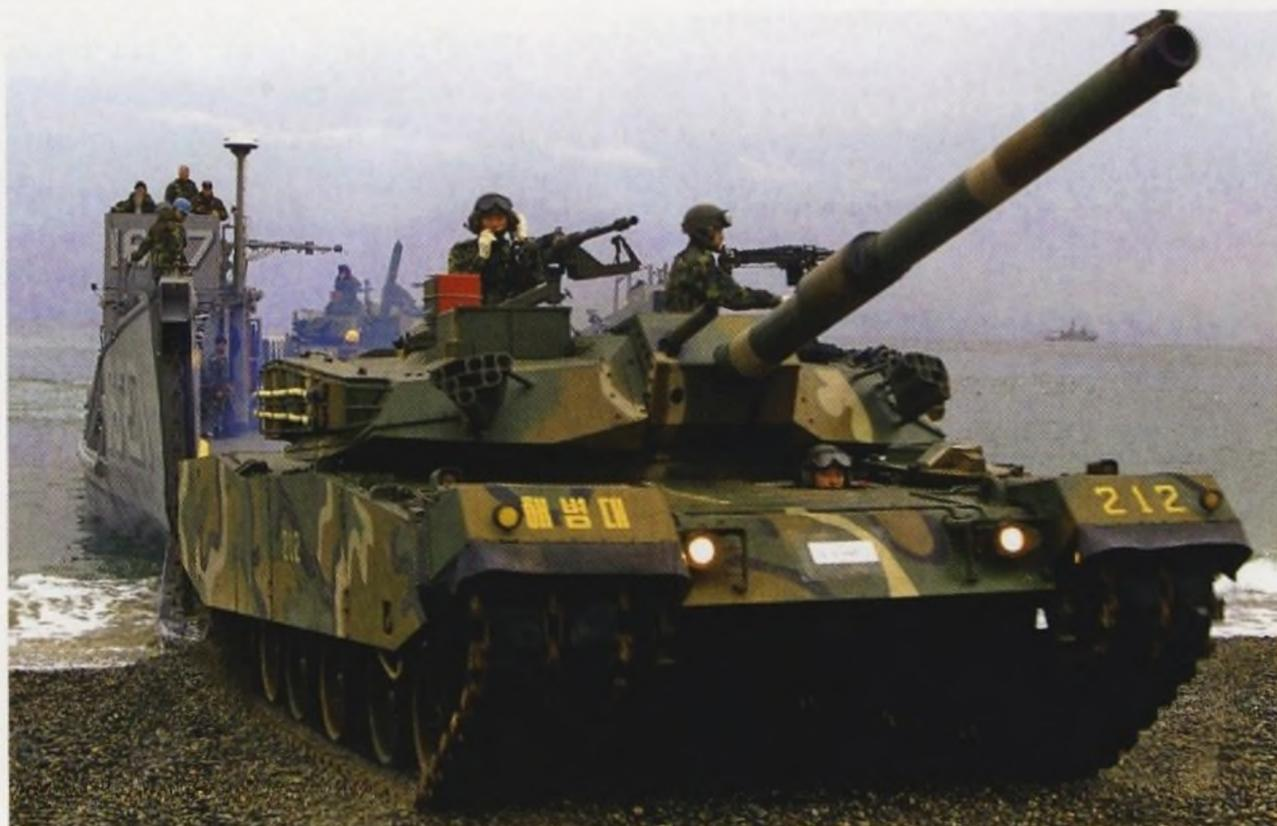
Южнокорейский основной танк Type 88 K1
