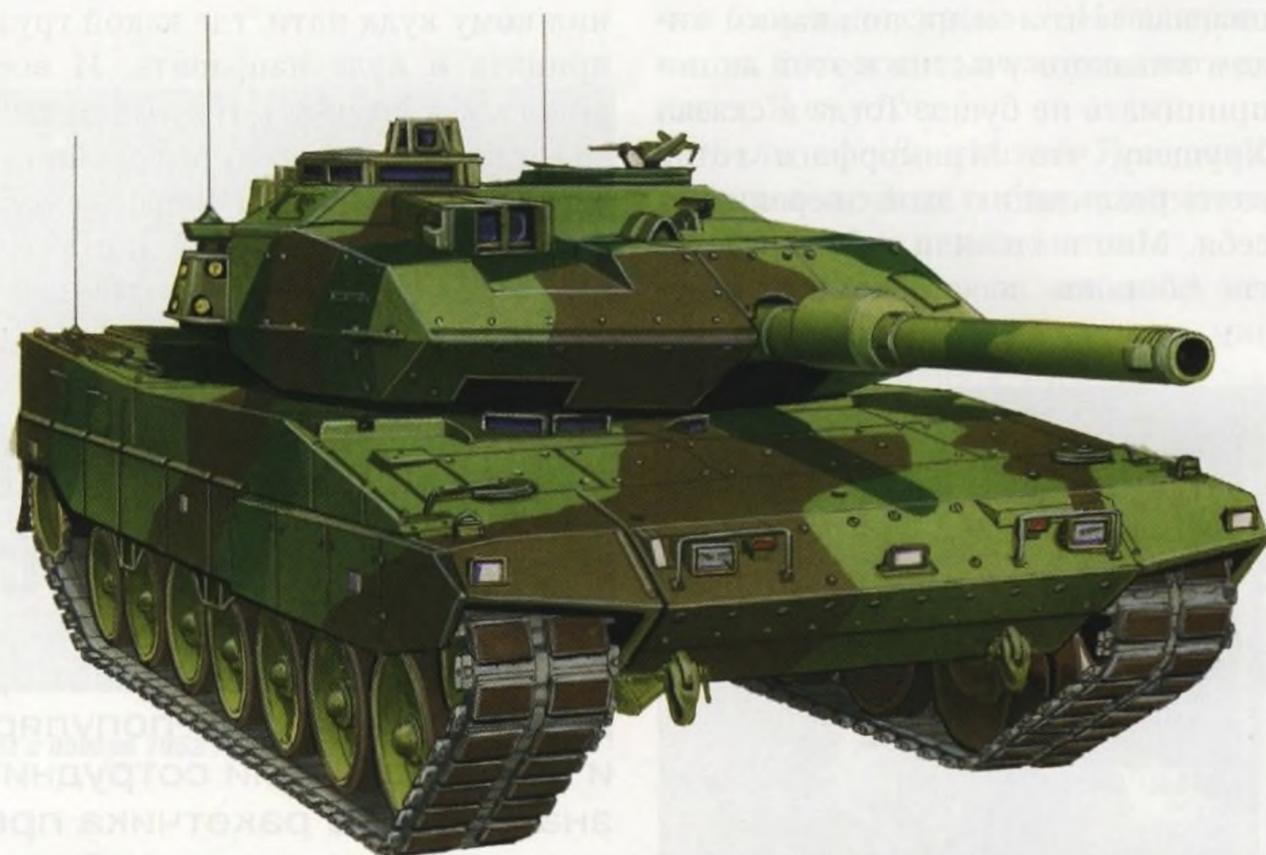
**Шведский танк Strv 122 (Leopard 2A5), первая боевая машина в Европе, оснащённая танковой информационно-управляющей системой**
