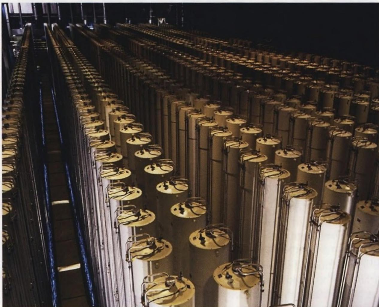
**Газовые центрифуги для разделения изотопов урана – одна из прорывных разработок Н.М.Синёва**
