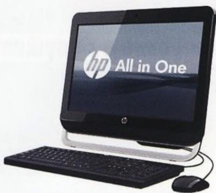
Компьютер-моноблок. Системный блок «упрятан» в корпус монитора
