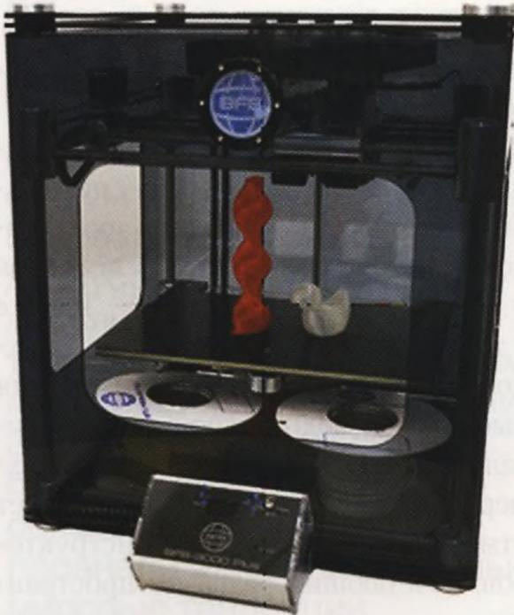
**Установка VFB-3000 фирмы 3D Systems Corporation. При габаритах 60 x 60 x 70 см и массе 38 кг агрегат позволяет изготавливать различные предметы габаритами до 27,5 x 27,5 x 20,0 см при точности 0,125 мм из пластика ABS или биоразлагаемого полимера, но изучается возможность использования других материалов. Из множества подобных устройств, которые можно уже и купить, VFB-3000 отличается тем, что может работать в невесомости. Пока, правда, испытания проводились на самолёте**
