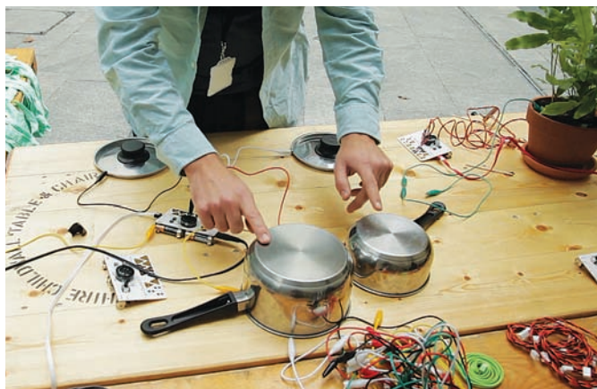
Процессор Ototo превращает кастрюли в электронные барабаны...
