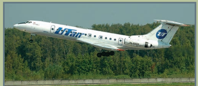
Самолёт для линий малой и средней протяжённости Ту-134 (выпущено 854 экз.) по некоторым показателям является выдающейся машиной. Так, до сих пор непревзойденными остаются ограничения по величинам встречной (30 м/с) и боковой (20 м/с) составляющих ветра при взлёте и посадке
