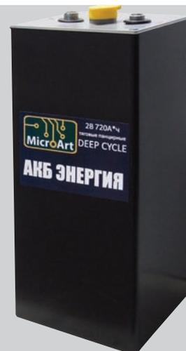
**с панцирными электродами (справа), особенно если вместо обычных пробок в них применяются пробки с рекуперацией выделяющихся при заряде газов. Они могут быть ёмкостью от 200 до 3000 Ач, но выполнены на напряжение 2 В. Соединяя их последовательно, можно получить и 12, и 24, и 48 В рабочего напряжения**
