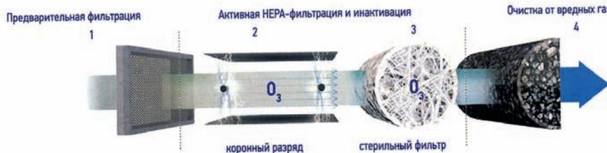
Схема устройства бактерицидного очистителя воздуха ТИОН-А
