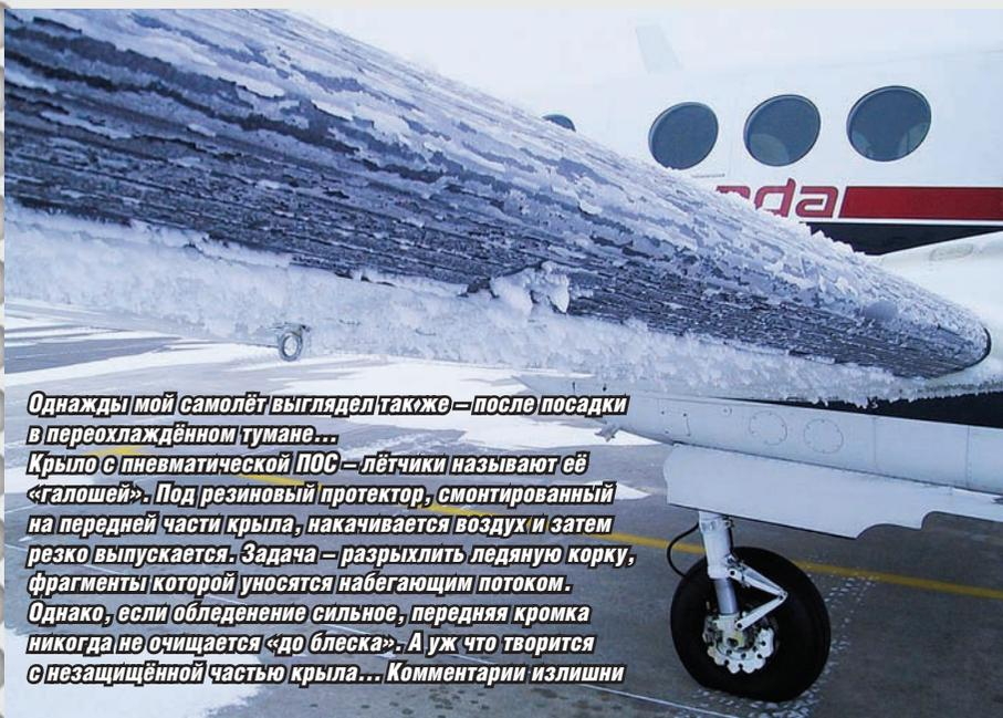
**Однажды мой самолёт выглядел так же — после посадки в переохлаждённом тумане... Крыло с пневматической ПОС — лётчики называют её «галашей». Под резиновый протектор, смонтированный на передней части крыла, накачивается воздух и затем резко выпускается. Задача — разрыхлить ледяную корку, фрагменты которой уносятся набегающим потоком. Однако, если обледенение сильное, передняя кромка никогда не очищается «до блеска». А уж что творится с незащищённой частью крыла... Комментарий излишни**
