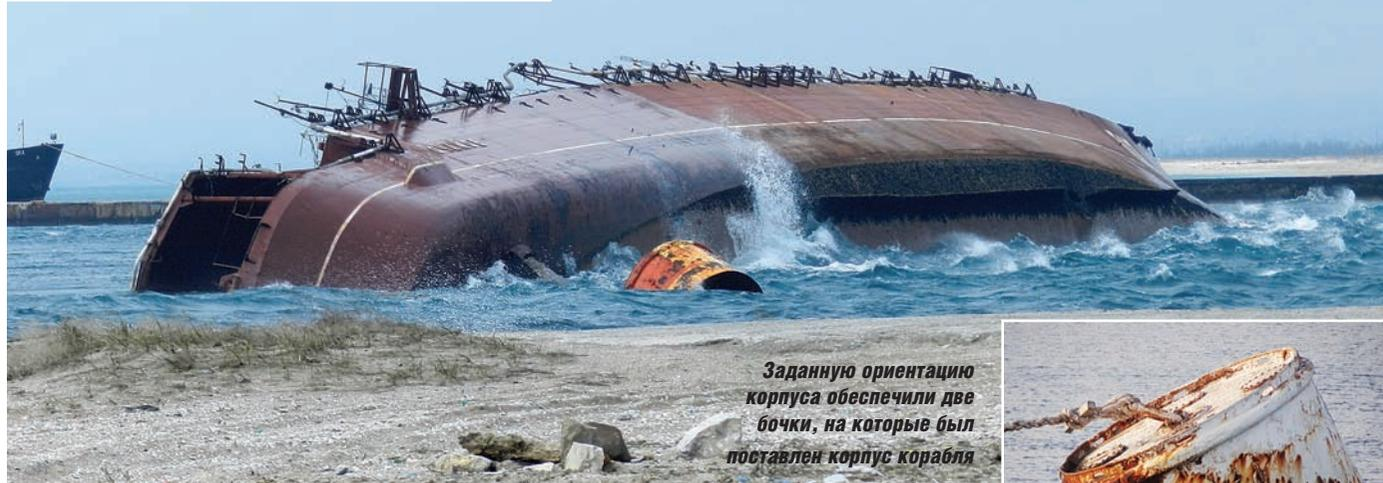
Заданную ориентацию корпуса обеспечили две бочки, на которые был поставлен корпус корабля
