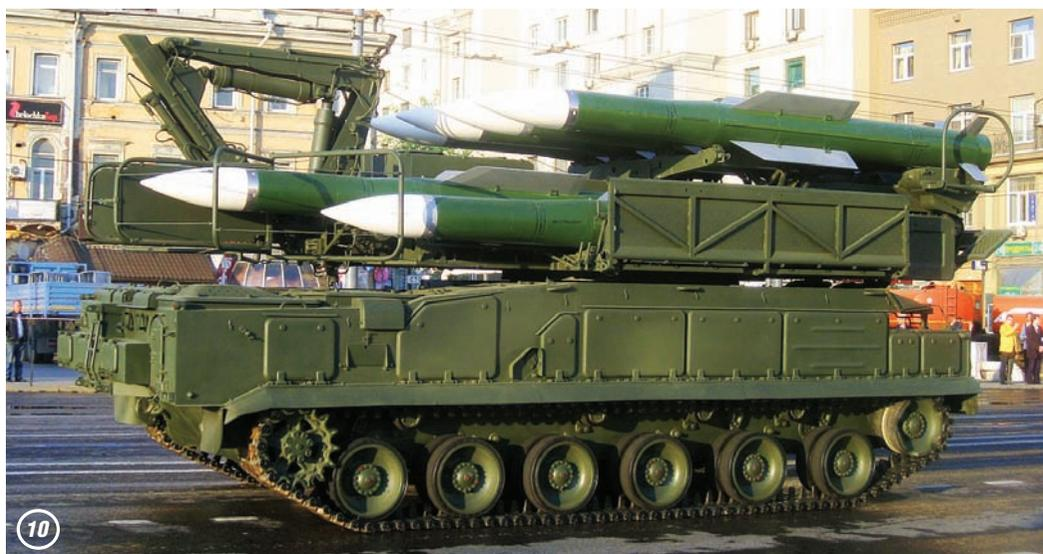
**10. Транспортная и пусковая установки ЗРК «Бук-М2» — многоцелевого комплекса средней дальности, который предназначен для уничтожения самолётов, вертолётов, крылатых, противорадиолокационных и тактических баллистических ракет. Также он может уничтожать корабли противника.**
