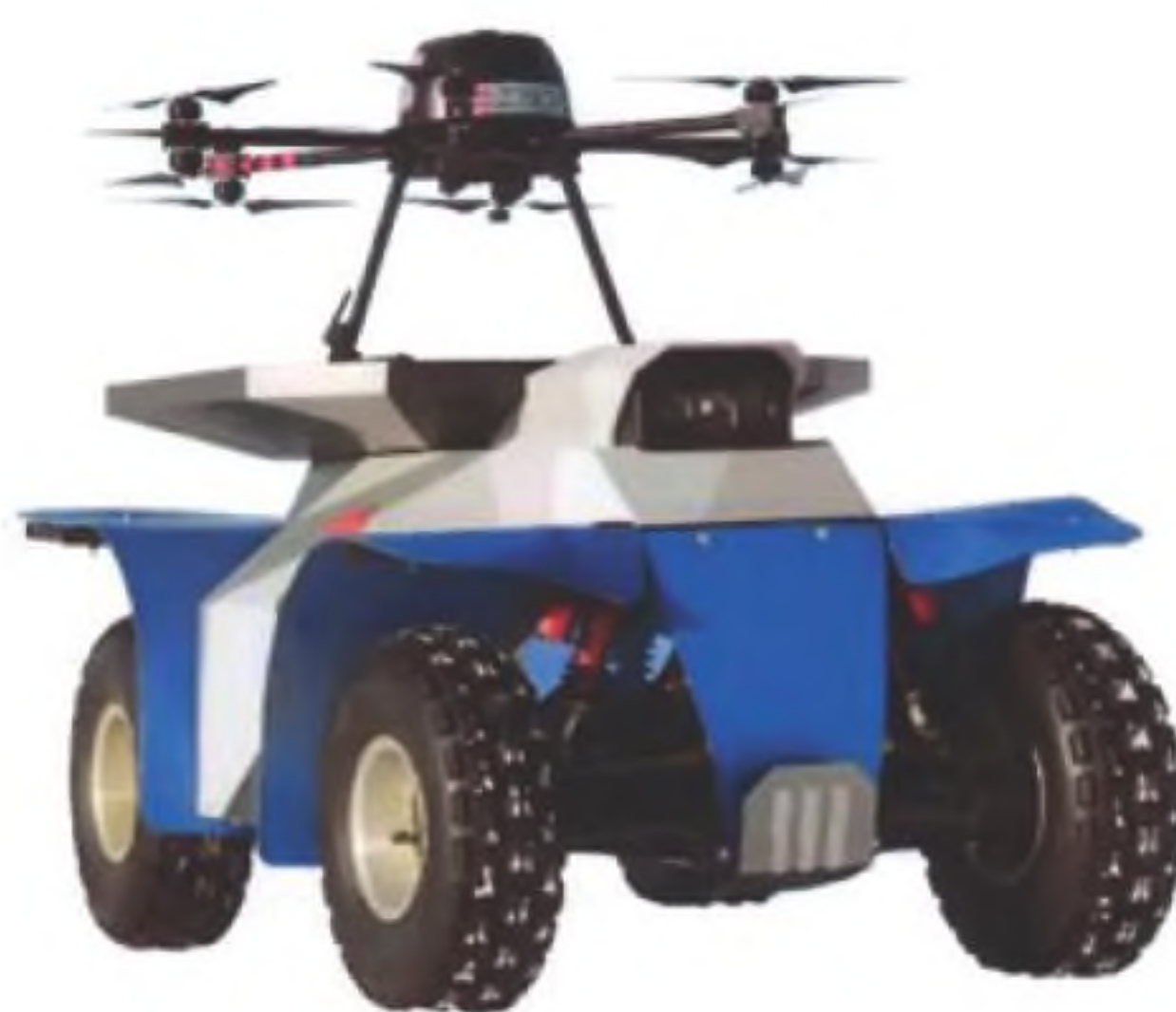
Многоцелевой роботизированный комплекс МАКС: вес — 70 кг, скорость — до 20 км/ч, запас хода — 120 км, нагрузка — 70 кг, Беспилотный вертолёт: скорость — 50 км/ч, высота полёта — 800 м
