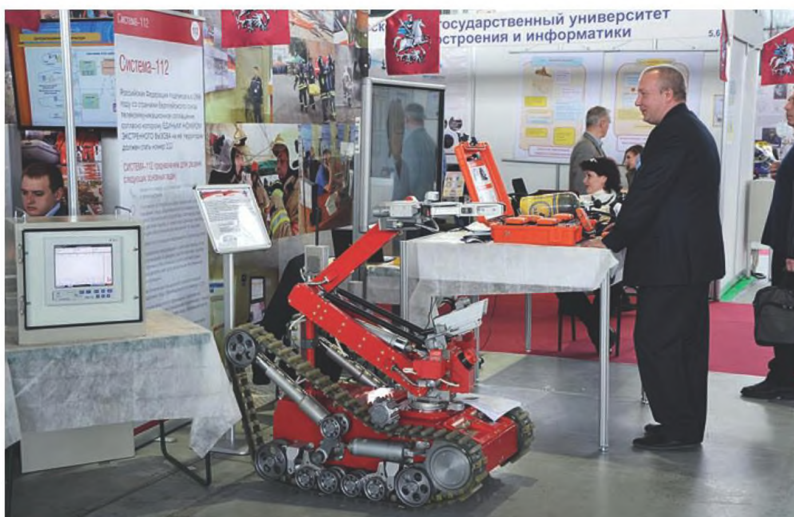
Мобильный робототехнический комплекс разведки и тушения пожаров МРК-РП: вес — 300 кг, длина — 1350 мм, ширина — 650 мм, высота — 700 мм
