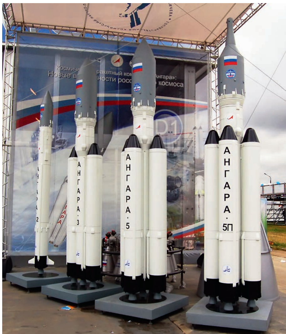
Макеты носителей «Ангара» на МАКС-2009. Здесь представлены как раз те модификации, о которых идёт речь в статье (слева направо): лёгкая «Ангара А1.2», средняя «А3», тяжёлая «А5» и пилотируемая «А5П». Тех, кого интересует более подробная техническая информация, отсылаем к ТМ № 10 за 2001 г.
