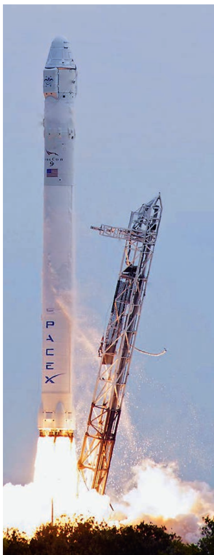
«Фолкен-9 v1.0» (8 т на НОО) стартует с грузовой версией корабля «Дрэгон»
