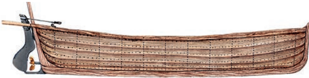
Паровой катер для промера (машина условно не показана) Длина, м 7,8 Ширина, м 1,98
