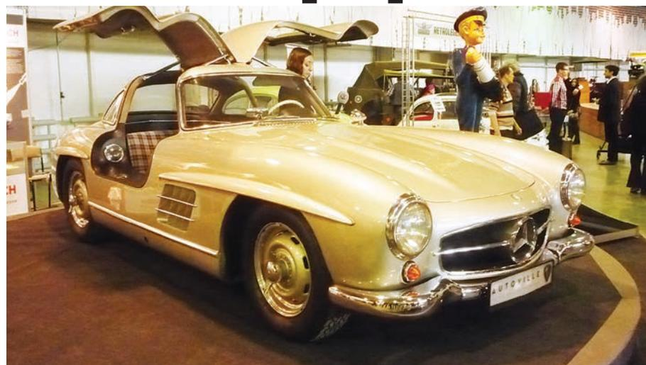
«Mercedes-Бенц 300СЛ», на котором впервые применен впрыск топлива в цилиндры
