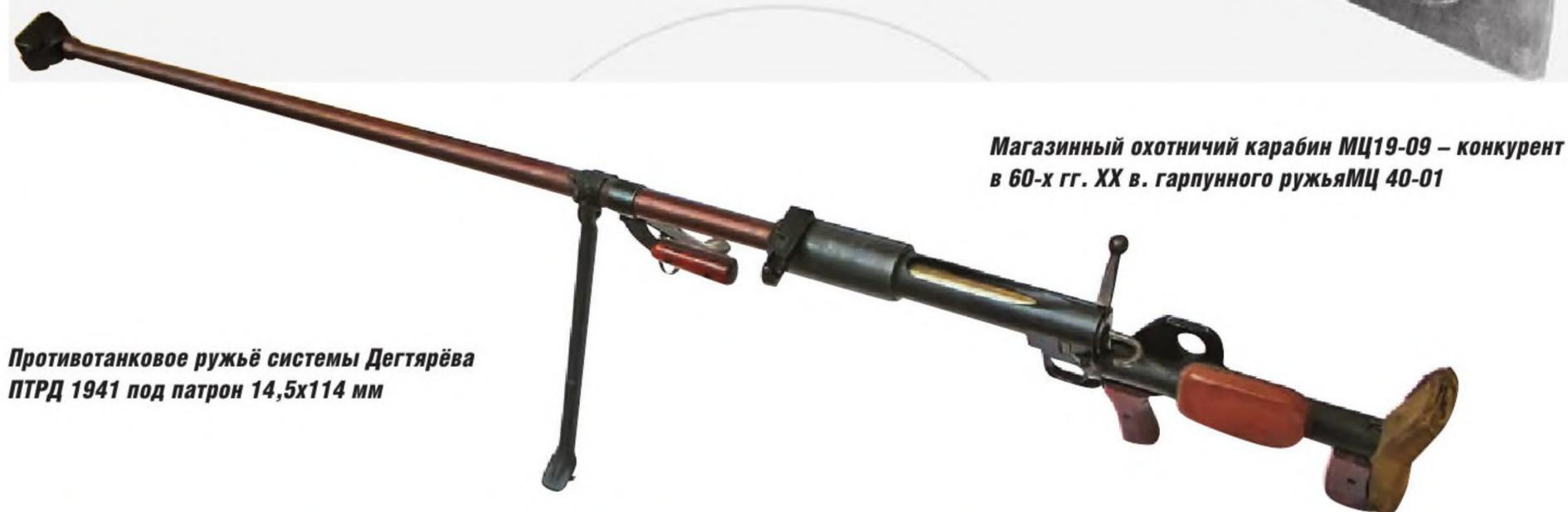
Противотанковое ружьё системы Дегтярёва ПТРД 1941 под патрон 14,5x114 мм
