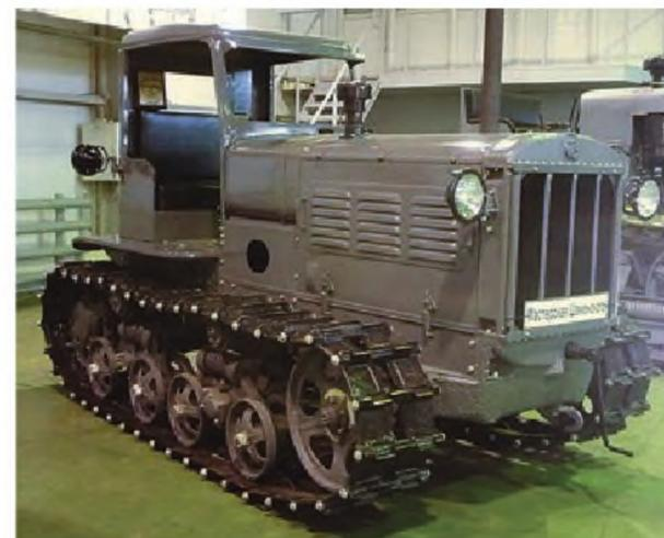
▲ СТЗ-3 — гусеничный трактор средней мощности общего назначения
