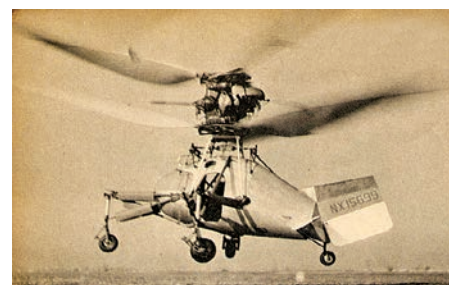
Последний вертолёт Г.А. Ботезата (около 1942 г.). Пилот Б.И. Сергиевский. Хорошо заметен двигатель, расположенный между винтами
