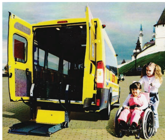
Школьный автобус с подъёмником для инвалидных колясок
