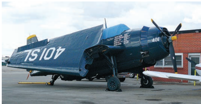
Американский палубный торпедоносец времён Второй мировой войны TBF «Звэнджер» со сложенными крыльями. Именно так такие самолёты хранились во внутренних ангарах авианосцев. Современное фото
