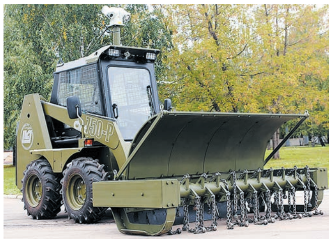
Автономная платформа на базе погрузчика
