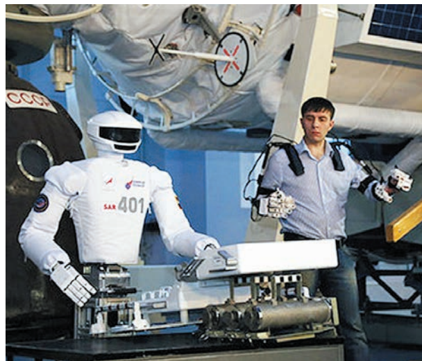
Антропоморфный робот SAR-401 копирует действия оператора
