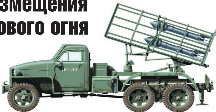
Пусковая установка БМ-31-12 реактивных снарядов на шасси автомобиля «Студебекер», 1944 г.
