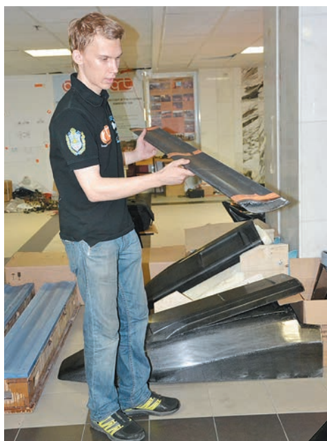
Профиль аэродинамической обвески — «антикрыло»
