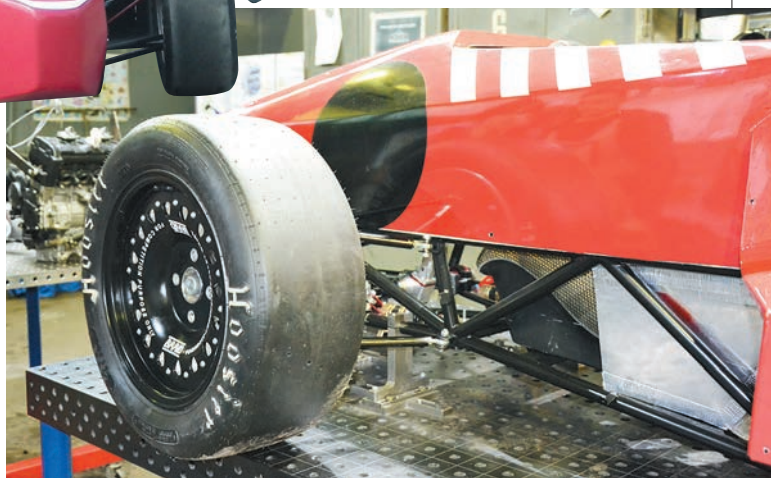
Автомобиль команды FS RUDN обретает свои формы. Идеальный стол для сборки и точного выставления рамы — подарок родного университета. Такого большого стола, чтобы умещался весь автомобиль, нет ни у одной московской команды
