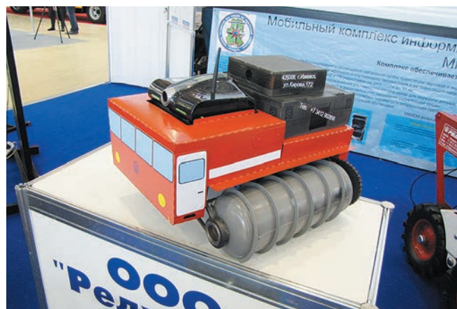
Разработчики ООО «Редуктор» предлагают использовать в качестве движителей вездеходов шнеки. Такой вездеход пройдёт даже по болоту
