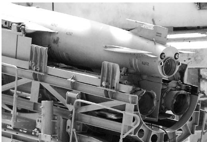
Ракета «Малахит». Хорошо видны ускорители. Фото из коллекции В. Костриченко
