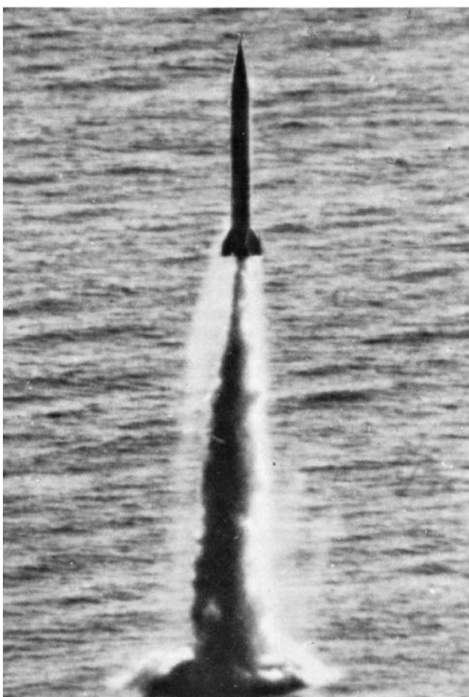
Старт макета С4.5 ракеты Р-11ФМ с погружаемого стенда
