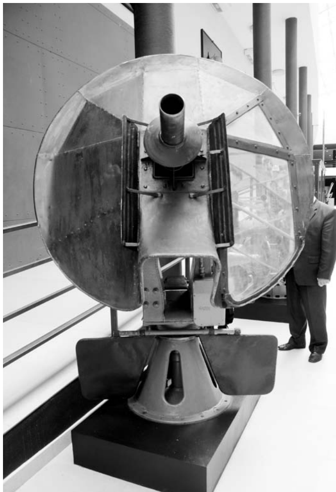
82-мм корабельная ракетная установка С-30. Вид спереди. Центральный Военно-морской музей. Фото А. Широкограда
