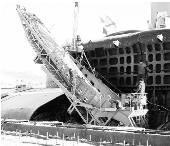
Погрузка ракеты «Гранит» на подводную лодку пр. 949. Фото из коллекции В. Костриченко
