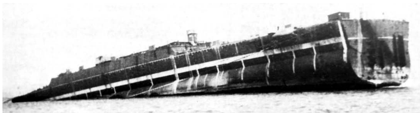
Отсек крейсера «Сталинград» после стрельбы
