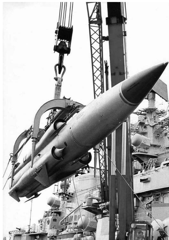
Ракета «Москит» с помощью крана перегружается с автомобиля на корабль. Фото из коллекции В. Костриченко
