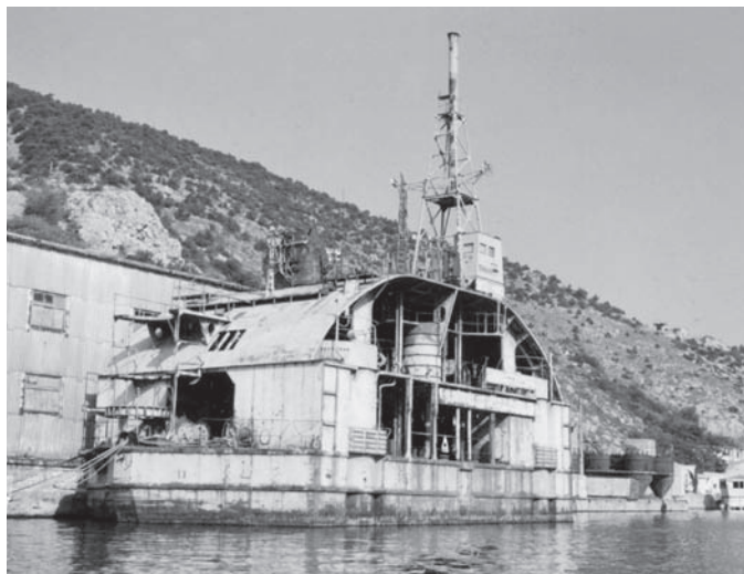
Погружающийся стенд для испытания ракет «Метеорит-М». Фото А. Широкограда
