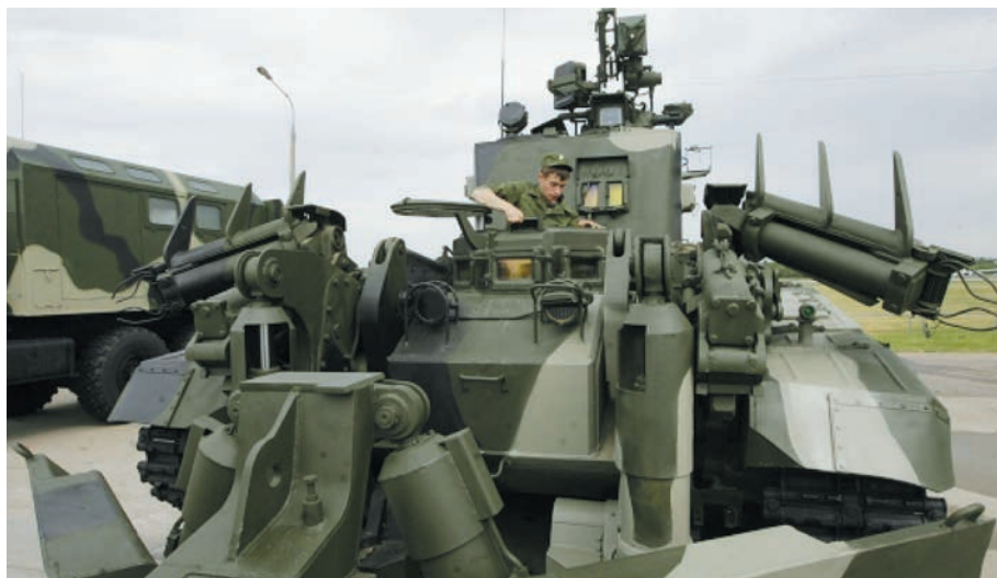
Инженерная машина «Горец-О» может разгрести завалы, пробивать заграждения и разминировать дороги под огнём противника
