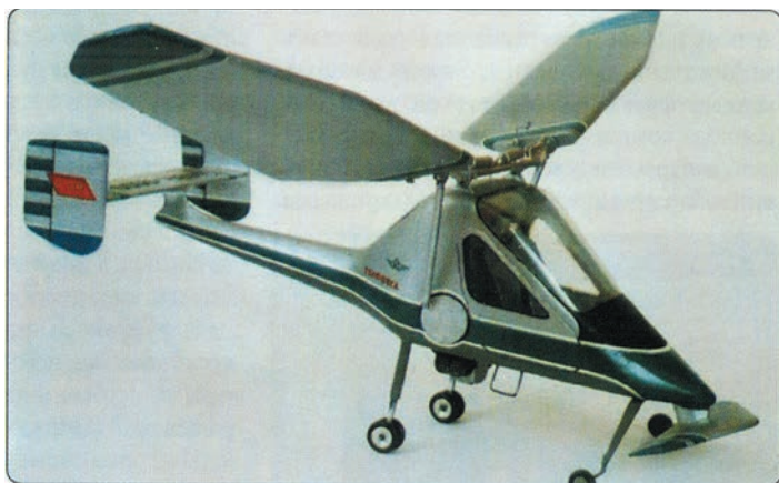
Модель экспериментального пилотируемого машущекрылого аппарата
