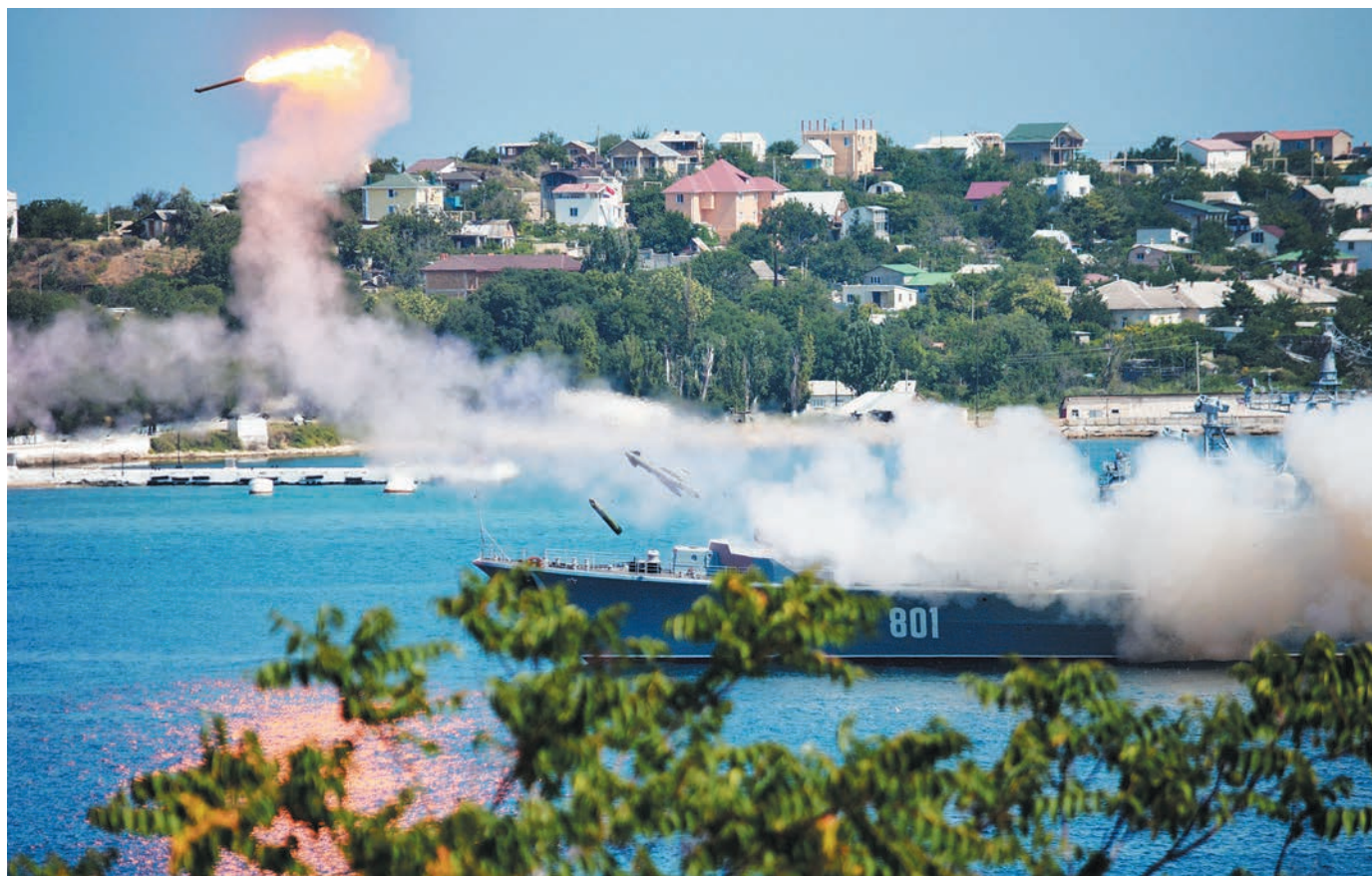
Торпеда продолжает падать. Ось вектора тяги ускорителя не совпадает с осью симметрии самого ускорителя, поэтому ускоритель летит по хаотичной траектории. Вот вектор его двигателя изменился, и ускоритель начинает падение (фото И. Кирсанова)
