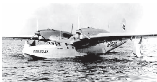
Четырёхмоторная дизельная летающая лодка Do-26 «Морской орёл»
