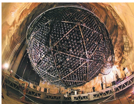
Детектор нейтрино на установке Sudbury Neutrino Observatory
