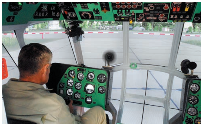
Мобильный тренажёр вертолёта Ми-8МТВ1. За стеклом виртуальный аэродром
