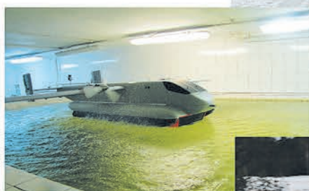
Радиоуправляемая модель СШВП движется по водной глади опытового бассейна
