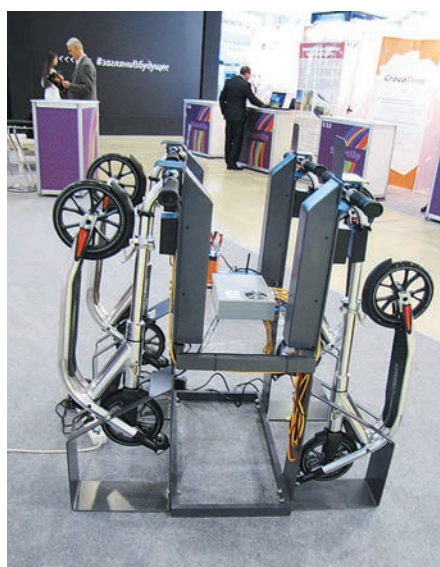
...Или велосипедам и самокатам. На снимке: автоматизированная стойка для самокатов, которые можно брать напрокат. Такую конструкцию предлагает фирма Alex Kostyrya
